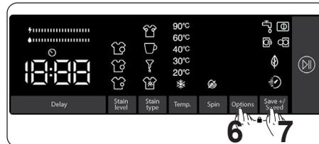
Wenn bei aktiver Kindersicherung eine Taste gedrückt oder das ausgewählte Programm über den Programmknopf geändert wird, blinkt das „CL“-Symbol 2 Sekunden lang auf der elektronischen Anzeige.
