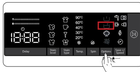
Mit dieser Zusatzfunktion können Sie dem Programm einen zusätzlichen Spülschritt zufügen. Aktivieren Sie die Extrapülen-Funktion, indem Sie die Optionstaste
