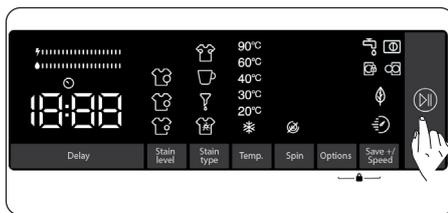
Durch Drücken der Start/Pause-Taste können Sie ein ausgewähltes Programm starten oder ein bereits laufendes Programm anhalten. Falls Sie Ihre Maschine in den Bereitschaftsmodus schalten, blinkt die Start/Pause-LED am Display.
