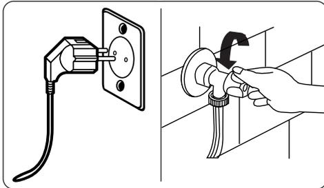
Schalten Sie Ihre Maschine aus und ziehen Sie den Netzstecker aus der Steckdose, bevor Sie Wartungs- oder Reinigungsarbeiten an ihr vornehmen.
