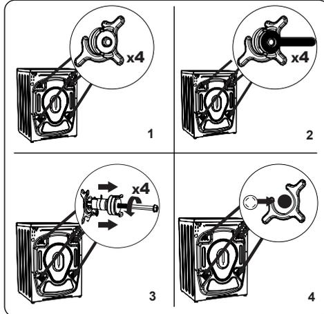
1. Entfernen Sie vor Inbetriebnahme der Waschmaschine unbedingt die 4 Transportschrauben und Gummiabstandhalter an der Rückseite des Gerätes. Falls die Schrauben nicht entfernt werden, können sie starke Vibrationen, Geräusche und Fehlfunktionen des Gerätes verursachen und die Garantie erlöschen lassen.
