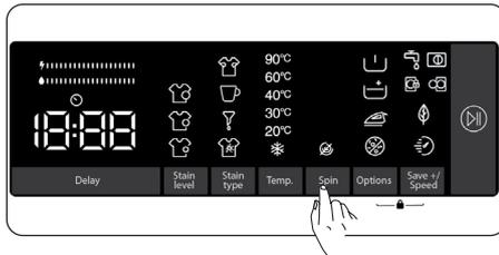
Sie können die Schleudergeschwindigkeit für Ihre Wäsche über die Schleudereinstelltaste festlegen. Wenn Sie ein neues Programm wählen, wird die maximale Schleudergeschwindigkeit des ausgewählten Programmes an der Schleudergeschwindigkeit-Anzeige angezeigt.
