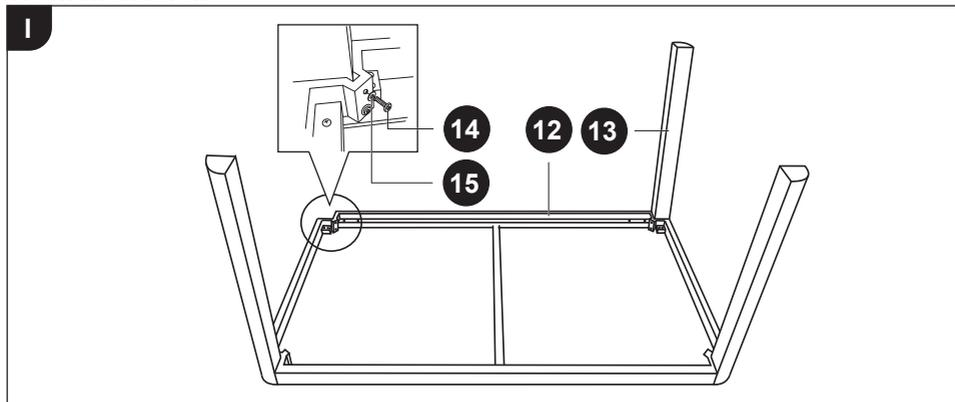
1. Schrauben Sie die 4 Tischbeine **13** mit 8 M6 × 35 mm Schrauben **14** an das Tischgestell **12** (siehe **Abb. I**).
