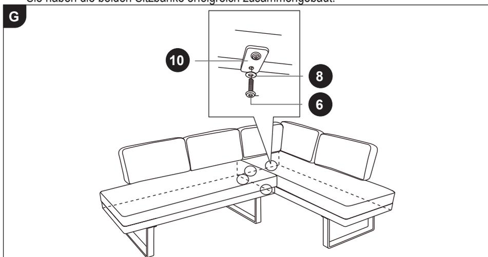
7. Verbinden Sie die beiden Sitzbänke, indem Sie sie mit 8 M6 × 15-mm Schrauben und 2 Unterlegscheiben (M40 × 20) **10** fest schrauben (siehe **Abb. G**).
