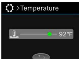
Mit der Temperatur Einstellung kann die Wassertemperatur festgelegt werden. Die Wassertemperatur kann zwischen 10°C - 40°C eingestellt werden, dieses erfolgt mit den Navigationstasten „**Links**“ und „**Rechts**“. Die ausgewählte Wassertemperatur ist festgelegt, sobald das Menü verlassen wird. Ist die Wassertemperatur niedriger, beginnt die Heizung automatisch zu heizen.
