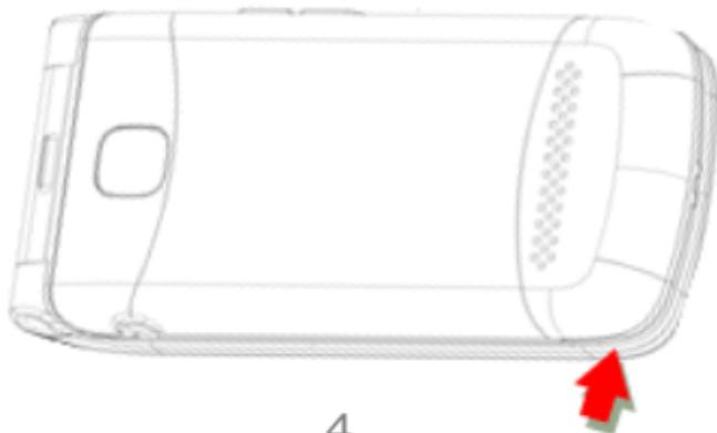
3. Sollte der Akku im Gerät sein, bitte entfernen Sie diesen.
