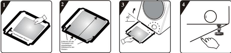
**1** Bevor Sie die Schalldämmplatte an der Sockelleiste installieren, richten Sie bitte die schallabsorbierende Watte entlang der rechtwinkligen Aussparung auf der unteren Abdeckung aus und kleben Sie sie auf (dieser Schritt kann bei einigen Modellen ohne schallabsorbierende Watte entfallen).
