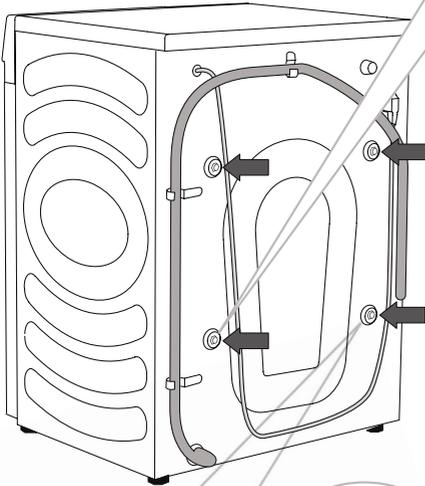
Hier befindet sich auch eine Kabelklemme, die ebenfalls entfernt werden muss.
