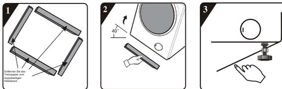
**1** Entfernen Sie das Trennpapier vom doppelseitigen Klebeband auf den Schwammstreifen.
