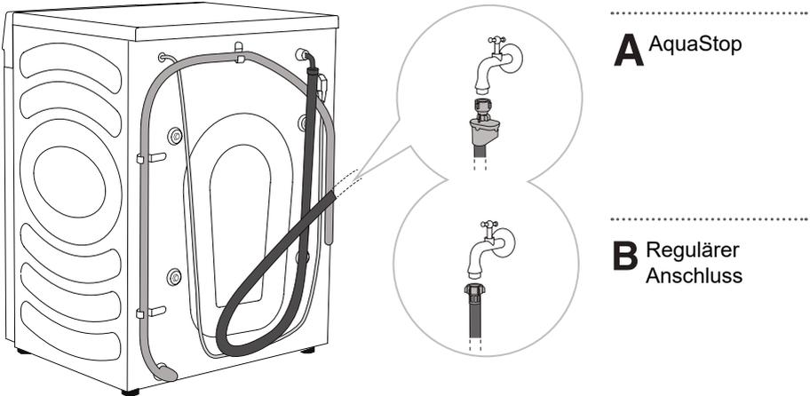
⚡ Für den normalen Betrieb der Waschmaschine muss der Wasserdruck zwischen 0,1 - 1 MPa (1 - 10 bar; 1 - 10 kp/cm<sup>2</sup>; 10 - 100 N/cm<sup>2</sup>) liegen. Der minimale dynamische Wasserdruck kann durch Messung des Wasserdurchflusses bestimmt werden. Aus einem vollständig geöffneten Wasserhahn sollten in 15 Sekunden 3 Liter Wasser fließen.
