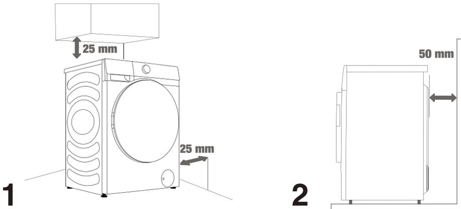
⚠ Die Waschmaschine darf nicht mit einer Wand oder einem Möbelstück in Berührung kommen. Um einen optimalen Betrieb zu gewährleisten, lassen Sie um die Waschmaschine herum etwas Platz, wie in der Abbildung angegeben. Die Nichteinhaltung der erforderlichen Mindestabstände kann zu einem unsicheren oder anormalen Betrieb führen. Außerdem kann es zur Überhitzung kommen (Abbildung 1 und 2).
