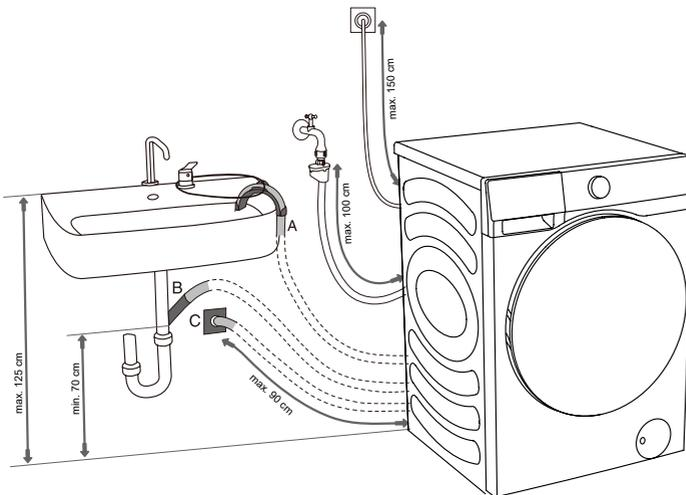
**A** Das Ende des Ablaufschlauchs kann über ein Waschbecken oder eine Badewanne gelegt werden. Verwenden Sie einen Spanngurt, um den Schlauch durch den Ellbogen zu sichern, damit er nicht verrutscht.
