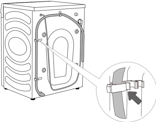
**D** Der Ablaufschlauch muss an den Haken auf der Rückseite der Waschmaschine befestigt werden, wie in der Abbildung gezeigt.
