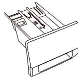
**2** Reinigen Sie das Waschmittelfach unter fließendem Wasser mit einer Bürste, und trocknen Sie es ab. Entfernen Sie auch alle Waschmittelreste vom Boden des Gehäuses. Nehmen Sie den Weichspüler-Einsatz aus dem Waschmittelfach. Waschen Sie alle Teile unter fließendem Wasser und setzen Sie sie wieder in das Gehäuse des Waschmittelfachs ein.
