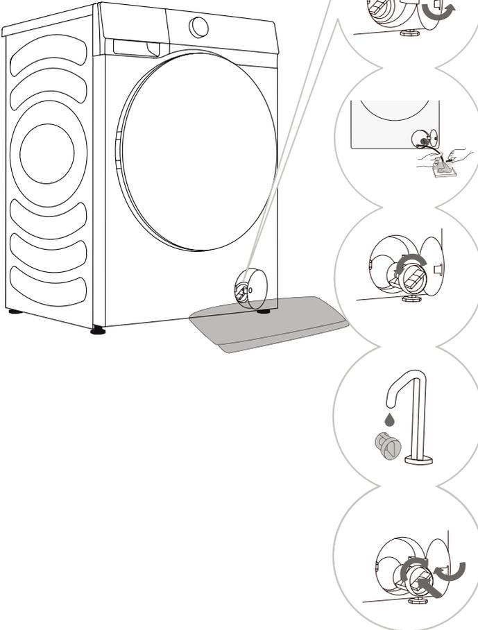
**1** Öffnen Sie die Klappen des Pumpenfilters (drücken Sie auf die Klappen, damit springt sie auf).
