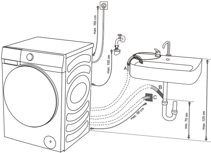
**C** Der Ablaufschlauch kann ebenfalls an einem Abfluss mit Siphon befestigt werden, der ordnungsgemäß installiert sein muss, um eine Reinigung zu ermöglichen.
