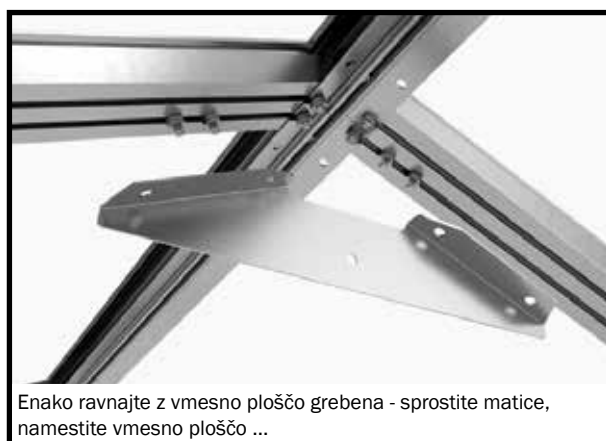
Odstranite matice z vijakov, vstavljenih v spojne profile, namestite vijake v linijo z luknjami v žlebni plošči in jo namestite na mesto.
