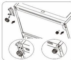
8. Bringen Sie die Tür in die Grundstellung, stellen Sie das untere Scharnierteil ein und richten Sie die Scharnierachse in das untere Loch der Tür ein.
