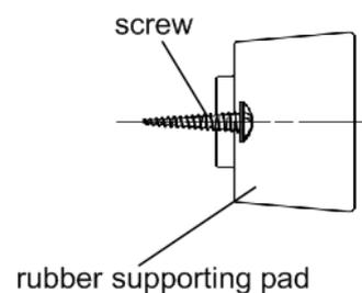
3. Richten Sie die Schraube auf das Loch auf der unteren Sockelblende. Befestigen Sie die GummifüÙe mit einem Kreuzschlitzschraubendreher (selbsterstellt) fest an der Sockelblende.
