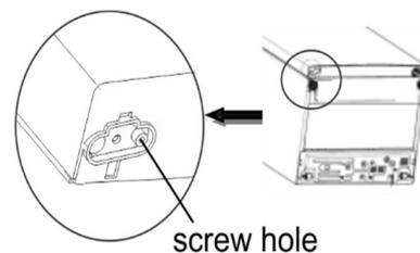
2. Setzen Sie die Schraube in das Loch der GummifüÙe.
