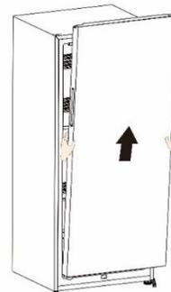
4. Legen Sie sie mit dem Panel nach oben auf eine glatte Oberfläche. Lösen Sie die Schraube 2 und das Teil 1, und installieren Sie sie dann auf die linke Seite und sie fest anziehen.
