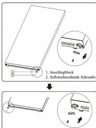
5. Legen Sie den Kühlschrank auf die weiche Schaumstoffverpackung oder auf ein ähnliches Material. Entfernen Sie beide einstellbaren Bodenfüße und entfernen Sie die vordere Fußplatte und das untere Scharnierteil, indem Sie die speziellen Flanschschneidschrauben abschrauben.
