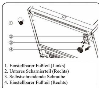
6. Lösen Sie den unteren Scharnierstift, wechseln Sie ihn in die umgekehrte Lochposition, und ziehen Sie ihn dann entsprechend der Abbildung unten fest.
