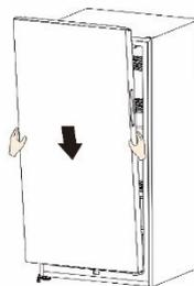
9. Versetzen Sie das obere Scharnierteil und führen Sie die obere Scharnierachse in das obere Loch der Tür. Passen Sie die Position der Tür an (stützen Sie die Tür dabei bitte mit der Hand ab) und befestigen Sie das obere Scharnierteil mit den speziellen Flansch selbstschneidenden Schrauben.
