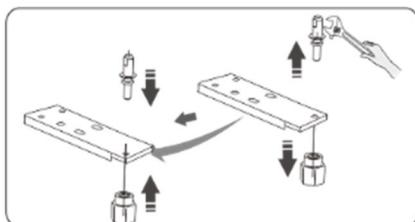
7. Ersetzen Sie das untere Scharnierteil auf die linke Seite und befestigen Sie es mit den speziellen Flanschschneidschrauben. Ersetzen Sie die verstellbare Fuß-Festplatte auf eine andere Seite und befestigen Sie sie.
