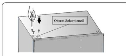
10. Montieren Sie die große Schraubenlochabdeckung (in der Plastiktüte) in der oberen rechten Ecke des Kühlschranks. Montieren Sie die obere Scharnierabdeckung (in der Plastiktüte) auf der linken Ecke. Setzen Sie die andere obere Scharnierabdeckung in die Plastiktüte.
