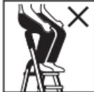
Multifunctionele schaal of borgbeugel van de trapladder niet als treevlak gebruiken.
