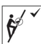
Při práci na žebříku se jednou rukou pevně držte, nebo pokud to není možné, zajistěte přídavná bezpečnostní opatření.
