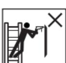
Evite trabalhos que possam submeter as escadas e/ou os escadotes a cargas laterais, p.ex. perfuração de materiais sólidos (p.ex. muros ou betão) em posição virada para o lado.
