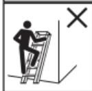
Vrijstaande ladders mogen niet worden gebruikt als aanlegladder, tenzij zij hiervoor zijn ontworpen.
