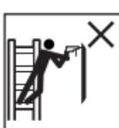
硬い物質(壁やコンクリート)を横方向からドリル穿孔するなど、脚立に横方向荷重をかける作業を避けてください。
