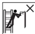
Evite cargas laterais excessivas, p.ex. durante a perfuração de muros e concreto.
