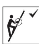
Sujetarse firmemente a la escalera al subir y bajar de la misma. Al realizar trabajos sobre una escalera, sujetarse con una mano y, si esto no es posible, tomar medidas de seguridad adicionales.
