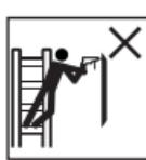
Zabránit práci, která způsobuje boční zatížení stojících žebříků, např. boční vrtání do pevných materiálů (např. zeď nebo beton).
