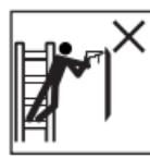
Éviter les efforts latéraux trop importants, p.ex. perçage de trous dans les murs et le béton.
