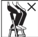
**Ne pas utiliser le plateau multifonction ou l'étrier de retenue de l'escabeau en tant que siège.**
