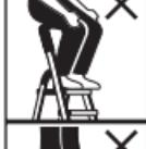
请勿将单侧人字梯的多功能托板或固定夹用作支撑面。
