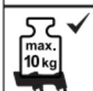
**Maksimal belastning er 10 kg på multifunksjonsskallet og festemekanismen på trappestigen.**
