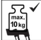
Multifunctionele schaal of borgbeugel van de trapladder met maximaal 10 kg beladen.
