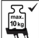
Multifunktions-Schale oder Haltebügel der Stufenstehleiter mit maximal 10 kg belasten.
