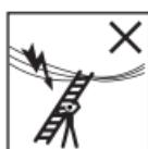
Varování. Nebezpečí úrazu elektrickým proudem. Zjistěte si veškerá rizika daná elektrickými zařízeními v pracovním prostoru, např. venkovní vedení vysokého napětí nebo jiná nezakrytá elektrická zařízení, a žebřík nepoužívejte, pokud hrozí riziko úrazu elektrickým proudem.
