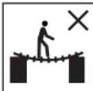
Μην χρησιμοποιείτε τη σκάλα ως γέφυρα.
