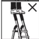
Multifunctionele schaal of borgbeugel van de trapladder niet als zitvlak gebruiken.
