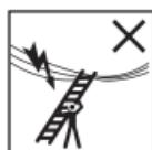
高電圧の架空線またはその他の電気機器など、作業エリア内の電気機器からのすべてのリスクを確認してください。感電の危険がある場合は、脚立を使用しないで下さい。
