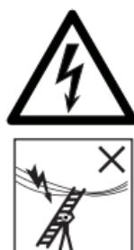
Stel alle door elektrische productiemiddelen in het werkbereik aanwezige risico's vast, b.v. bovengrondse hoogspanningsleidingen of andere onbedekte elektrische productiemiddelen. De ladder niet gebruiken als er risico's door elektrische stroom bestaan.
