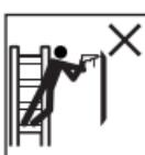
Не применяйте чрезмерную боковую нагрузку, как, например, при сверлении кирпичной или бетонной кладки.
