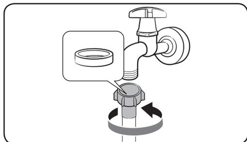
1. Schließen Sie den Wasserschlauch an den Wasserhahn an und drehen den Anschluss dann wie gezeigt im Uhrzeigersinn.
