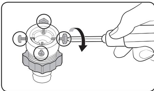
2. Lösen Sie die vier Schrauben am Adapter mithilfe eines Kreuzschlitz-Schraubenziehers.
