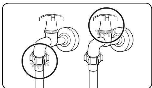
3. Öffnen Sie den Wasseranschluss und überprüfen Sie, ob sich Lecks um die Anschlussbereich herum befinden. Tritt an einer dieser Stellen Wasser aus, so wiederholen Sie die genannten Schritte.
