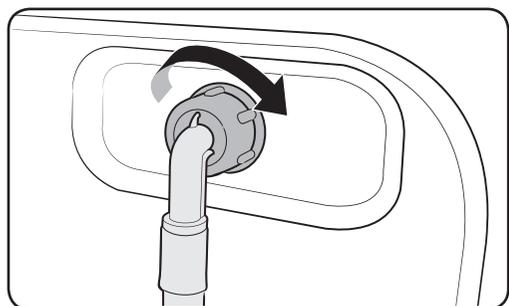
2. Verbinden Sie das andere Ende des Zuwasserschlauchs mit dem Eintrittsventil auf der Rückseite des Wäschetrockners. Drehen Sie den Schlauch im Uhrzeigersinn, um ihn festzuziehen.
