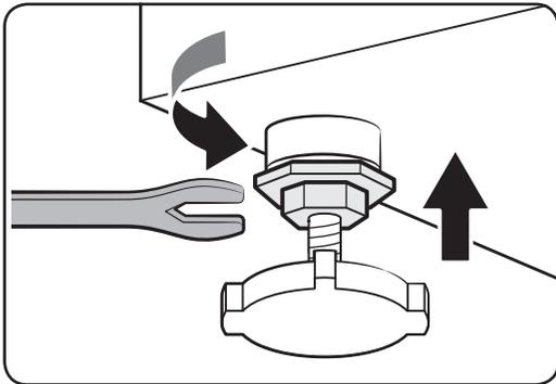
3. Nach Abschluss der Ausrichtung ziehen Sie die Kontermuttern mithilfe des Schraubenschlüssels fest.
