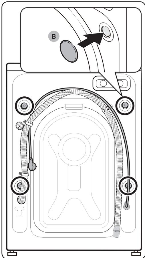
3. Setzen Sie die Abdeckungen (B) in die Löcher ein (in der Zeichnung mit einem Kreis markiert).
