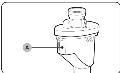
Der AquaStop-Schlauch warnt Benutzer vor der Gefahr eines Wasserlecks. Er spürt, wenn Wasser fließt, und die mittlere Anzeige (A) wird im Falle eines Lecks rot.
