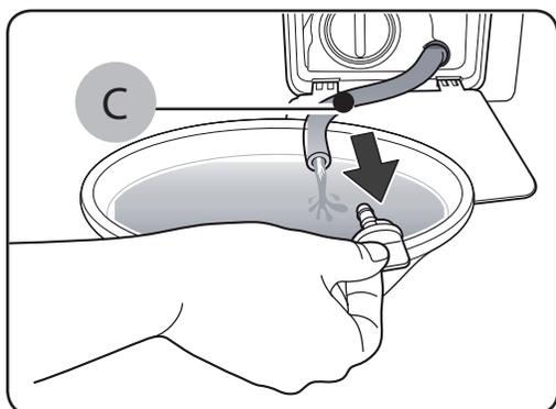
4. Öffnen Sie die Verschlusskappe und lassen Sie das Wasser im **Schlauch (C)** in den Behälter fließen.
