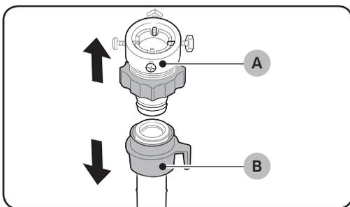
1. Entfernen Sie den Adapter (A) vom Zuwasserschlauch (B).
