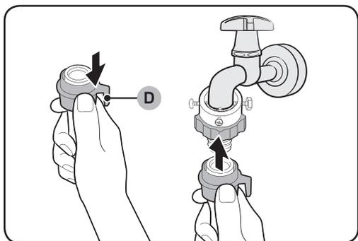
4. Setzen Sie den Adapter in den Wasserhahn ein und ziehen Sie dann die Schrauben fest, während Sie den Adapter anheben.
