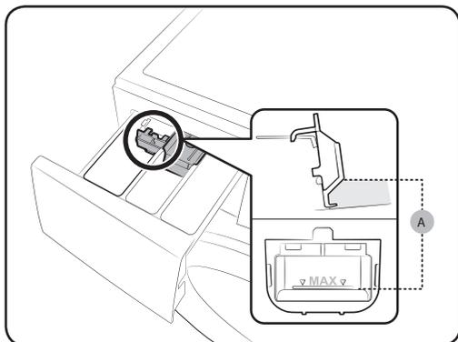
Stecken Sie zunächst den Flüssigwaschmittelbehälter in das **II** Waschmittelfach Hauptwäsche ein. Füllen Sie dann Flüssigwaschmittel bis unter die **Maximallinie (A)** in den Behälter ein.
