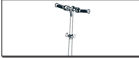
Ziehen Sie die Inbusschraube manuell fester oder lösen Sie sie etwas, um den Widerstand des Schnellspanners anzupassen.
