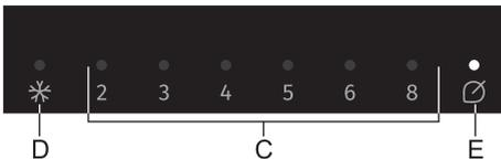
**Einschalten:** Um die **Eco** Funktion zu aktivieren, drücken Sie die Taste **B**, bis das Indikatorlämpchen oberhalb des Symbols **E** aufleuchtet. Wenn diese Funktion aktiviert ist, arbeitet das Gerät unter optimalen Einstellungen.
