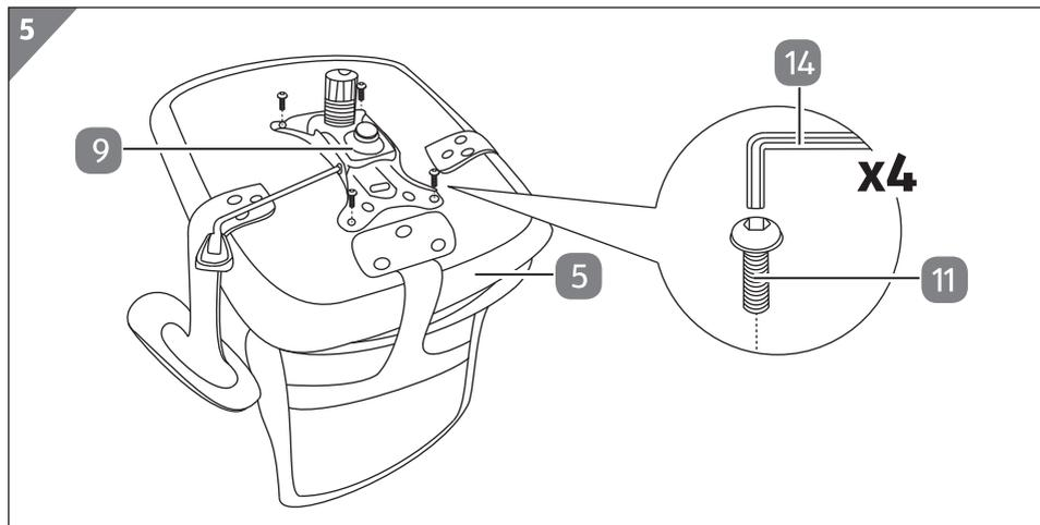
Schrauben Sie die Mechanik **9** wie abgebildet mit den Innensechskantschrauben **11** von unten auf die Sitzfläche **5**.
