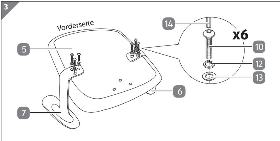
Schrauben Sie die Armlehnen **6**, **7** wie abgebildet mit den Innensechskantschrauben **10** und den Federscheiben **12**, Unterlegscheiben **13** von unten auf die Sitzfläche **5**.
