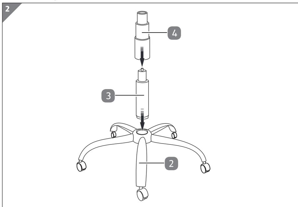
1. Stecken Sie die Sicherheitsgasfeder **3** in das Fußkreuz **2**.
