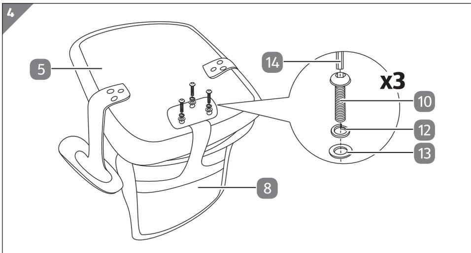
Schrauben Sie die Rückenlehne **8** wie abgebildet mit den Innensechskantschrauben **10**, den Federscheiben **12**, Unterlegscheiben **13** von unten auf die Sitzfläche **5**.
