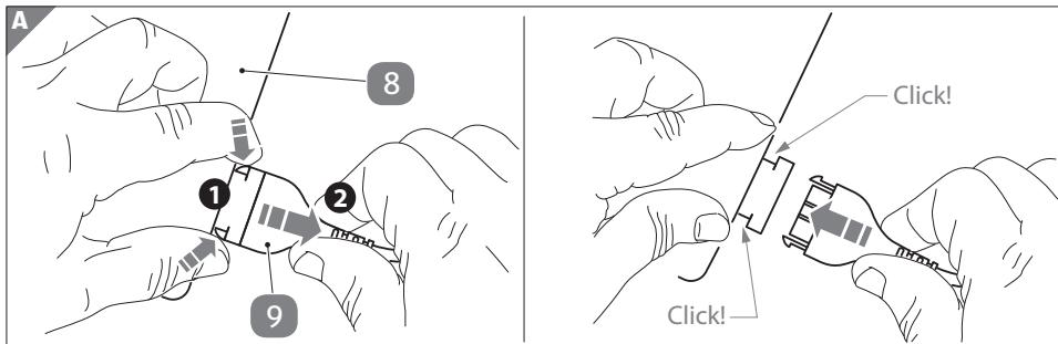
**REMARQUE !** Risque de dommages ! Ne tenez pas l'élément chauffant **8** pendant le débranchement ou le branchement de la prise du panneau de commande **9**.
