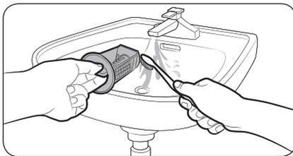
5. Reinigen Sie das Flusensieb mit einer weichen Bürste. Stellen Sie sicher, dass das im Inneren des Flusensiebs befindliche Propellerrad der Absaugpumpe nicht blockiert ist.
