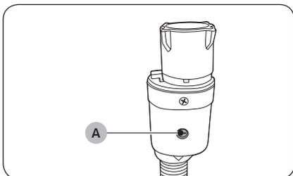
Der AquaStop-Schlauch warnt den Benutzer vor einem Wasseraustritt. Er misst den Wasserdurchfluss, und im Falle eines Lecks wechselt die **Anzeige (A)** in der Mitte des AquaStop-Schlauchs ihre Farbe zu rot.
