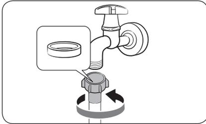
1. Verbinden Sie den Wasserschlauch mit dem Wasserhahn und drehen Sie den Anschluss dann im Uhrzeigersinn (siehe Abbildung).
