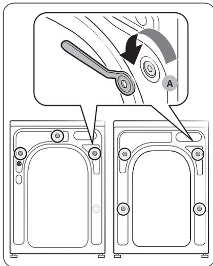
1. Suchen Sie die Transportsicherungen (in der Abbildung mit einem Kreis markiert) auf der Rückseite der Waschmaschine.
