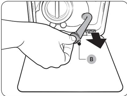
3. Stellen Sie in die Nähe der Abdeckung ein leeres Gefäß geeigneter Größe. Ziehen Sie den Notentleerungsschlauch dann heraus und legen Sie das Ende in das bereitstehende Gefäß. Halten Sie dabei die **Verschlusskappe (B)** fest.
