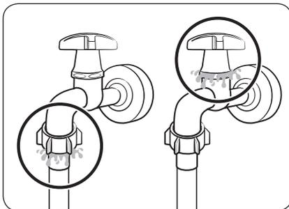
3. Öffnen Sie den Wasserhahn, und überprüfen Sie die Verbindungspunkte auf Lecks. Sollte tatsächlich Wasser austreten, müssen Sie die oben beschriebenen Schritte wiederholen.
