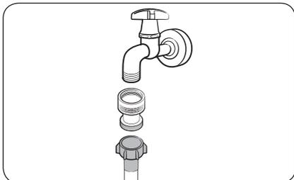
Bevor Sie den Wasserschlauch an einen Wasserhahn anschließen, müssen Sie den mitgelieferten Rückflussverhinderer an den Wasserhahn anschließen und dürfen erst dann den Wasserschlauch anschließen.
