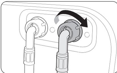
1. Schließen Sie das rote Ende des Warmwasserschlauchs an den Warmwasseranschluss auf der Rückseite der Waschmaschine an.
