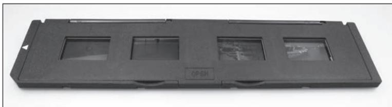
Führen Sie nun den Dia-Halter so von der rechten Seite in den Eingabeschlitz des Multi Scanners für Dia- und Negativ-Halter ein, dass die weiße Dreiecks-Markierung voran und sichtbar ist. Schieben Sie den Dia-Halter so weit in den Multi Scanner ein, bis dieser spürbar in der ersten Dia-Position einrastet.
