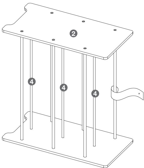
Die Stangen **4** aufrichten, in die Bohrung stecken. Dann die Schrauben **A** zu 100 % festziehen.
