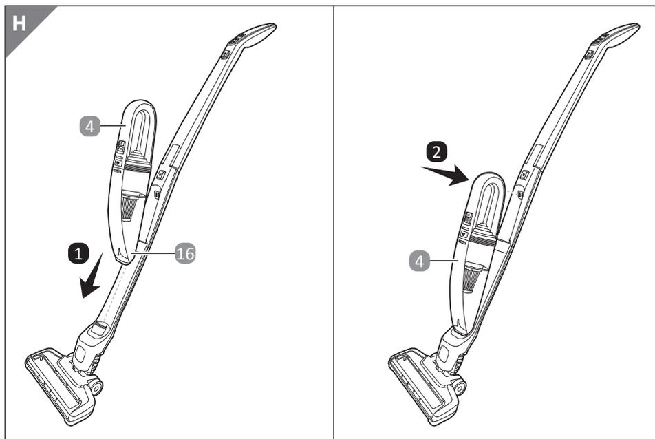
3. Spingere l'aspirapolvere portatile **4** all'indietro nell'alloggiamento finché l'aspirapolvere portatile **4** non scatta in posizione (fig. H).
