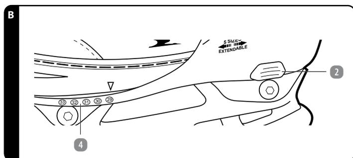
2. Premere e tenere premuto il bottone a pressione di regolazione della lunghezza **2**. In questo modo è possibile rimuovere l'arresto e regolare la dimensione (Fig. B).
