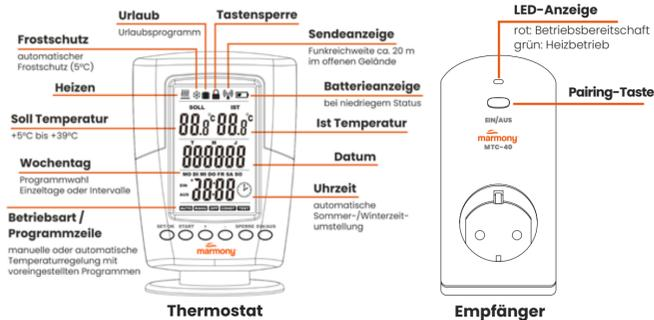
Abb. 08: Thermostat und Empfänger
