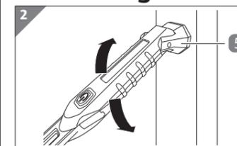
1. Fissare la lampada a superfici magnetiche tramite il supporto magnetico **5** (vedi Fig. 2). Accertarsi della tenuta salda della lampada prima di lasciarla con la mano. La tenuta della lampada dipende dal materiale della superficie.
