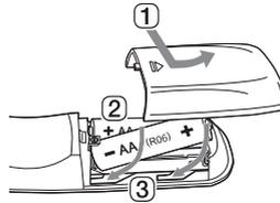
Benutzen Sie 1,5 V AA Batterien. Die zwei Batterien in der Richtung in die Fernbedienung einsetzen, wie es in der Abbildung gezeigt wird.
