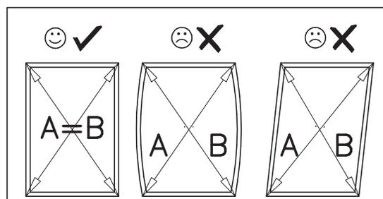
Aufbau / Construction / Costruzione / Szerelés / Gradnja
