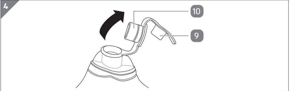
1. Lösen Sie den Stopfen des Bodenventils **9** (siehe **Abb. 4**).
