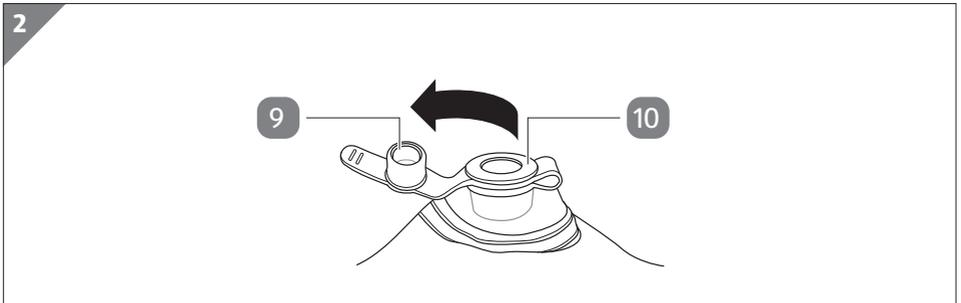
2. Lösen Sie den Stopfen des Bodenventils **9** (siehe **Abb. 2**). Stellen Sie sicher, dass das Bodenventil **10** fest mit dem Produkt verbunden bleibt, damit keine Luft entweichen kann.
