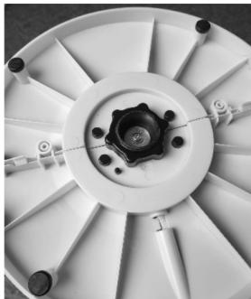
8. Introduisez maintenant le câble d'alimentation dans la fixation du câble de manière à ce que celui-ci ne bouge plus.
