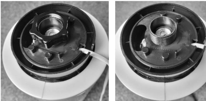
6. Nehmen Sie nun den Standfuß 1 zur Hand und setzen ihn auf die Unterseite des Gerätes. Achten Sie dabei darauf, dass die am Gerät vorhandenen Erhebungen passgenau in die dafür vorgesehenen Aussparungen am Standfuß 1 eingeführt werden.
