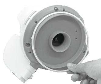
2. Con un cacciavite rimuovere le 4 viti nella parte inferiore della testina, in modo da smontare la piastra alla base. Svitare col cacciavite tutte le viti della base come indicato in figura. Rimuovere la girante, fare leva sulla piastra e rimuoverla, quindi scoprire l'interno.
