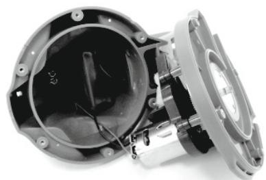
3. Retire el paquete de baterías para dejar a la vista el PCBA. Para soltar el cable de conexión de la batería, presione el clip del conector y luego tire de él hacia afuera. **NOTA:** Envuelva inmediatamente el conector con cinta aisladora, para evitar cortocircuitos provocados por el contacto de los dos terminales del cable.
