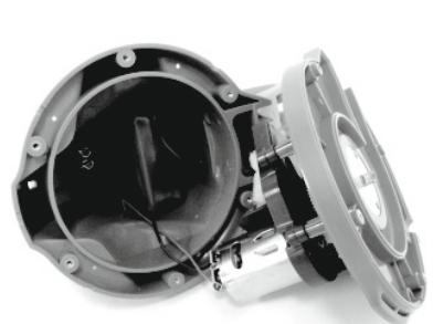
3. Verwijder de batterij om bij de printplaat te kunnen komen. Druk op de clip op de connector en trek die dan naar buiten om de verbindingsdraad van de batterij los te maken. **OPMERKING:** Omwikkel de pool onmiddellijk met isolatietape om kortsluiting door contact tussen de beide polen te voorkomen.
