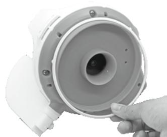
2. Użyć wkrętaka do odkręcenia 4 wkrętów znajdujących się w dolnej części głowicy, aby najpierw zwolnić płytę dolną. Użyć wkrętaka do odkręcenia wszystkich wkrętów podstawy, tak jak pokazano. Wymontować wirnik, a następnie podważyć podstawę i zdjąć ją, aby odsłonić wnętrze głowicy.
