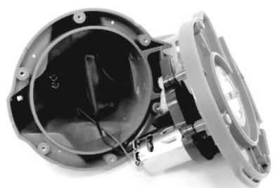
3. Retirez le bloc batterie pour exposer l'assemblage de cartes de circuits imprimés. Pour détacher le câble de connexion de la batterie, appuyez sur le clip sur le connecteur et retirez-le. **REMARQUE** : Enroulez immédiatement le connecteur avec du ruban isolant afin d'éviter tout court-circuit dû au contact des deux fils.
