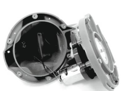
3. Remova a bateria para expor o PCBA. Para prender o cabo de ligação da bateria, prima o gancho no conector e puxe para fora. **NOTA:** Envolva o conector imediatamente com fita isoladora de forma a evitar curto-círcito provocado pelo contacto de ambos os terminais do fio.
