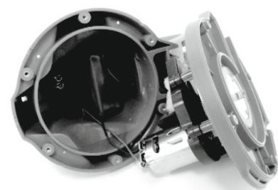
3. Estrarre la batteria per localizzare il circuito stampato. Scollegare il cavo batteria premendo sulla clip del connettore e tirando verso l'esterno. **NOTA:** Avvolgere i connettori con nastro isolante per evitare corti circuiti causati dal contatto tra entrambi i terminali.
