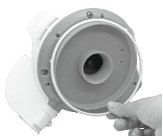
2. Use el destornillador para aflojar los 4 tornillos presentes en la parte inferior del cabezal, para soltar en primer lugar la placa inferior. Use el destornillador para aflojar todos los tornillos de la base, como se ve en la figura. Retire el impulsor y luego haga palanca en la base y retírela para dejar a la vista el interior del cabezal.
