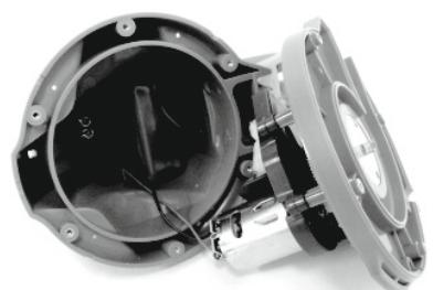
3. Távolítsa el az akkumulátorcsomagot a nyomtatott áramköri lap felfedéséhez. Az akkumulátor csatlakozókábelének a leválasztásához nyomja le a csatlakozón található kengyelt, és húzza ki a csatlakozót. **MEGJEGYZÉS:** A csatlakozót azonnal tekerje be szigetelőszalaggal, hogy megelőzze az egyéb kábelcsatlakozókkal való esetleges érintkezés okozta rövidzárlatot.
