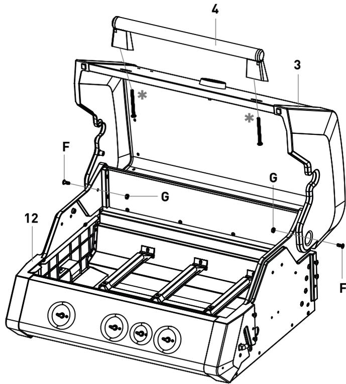
\* Entfernen Sie die Schrauben M6x80 und befestigen Sie diese mit dem Griff.
