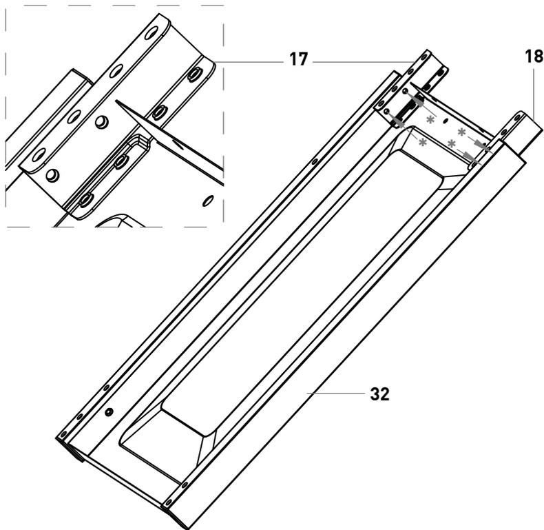
\* Zuerst die Schrauben M6x12 von der Seitenwand entfernen und die Halterungen damit befestigen.
