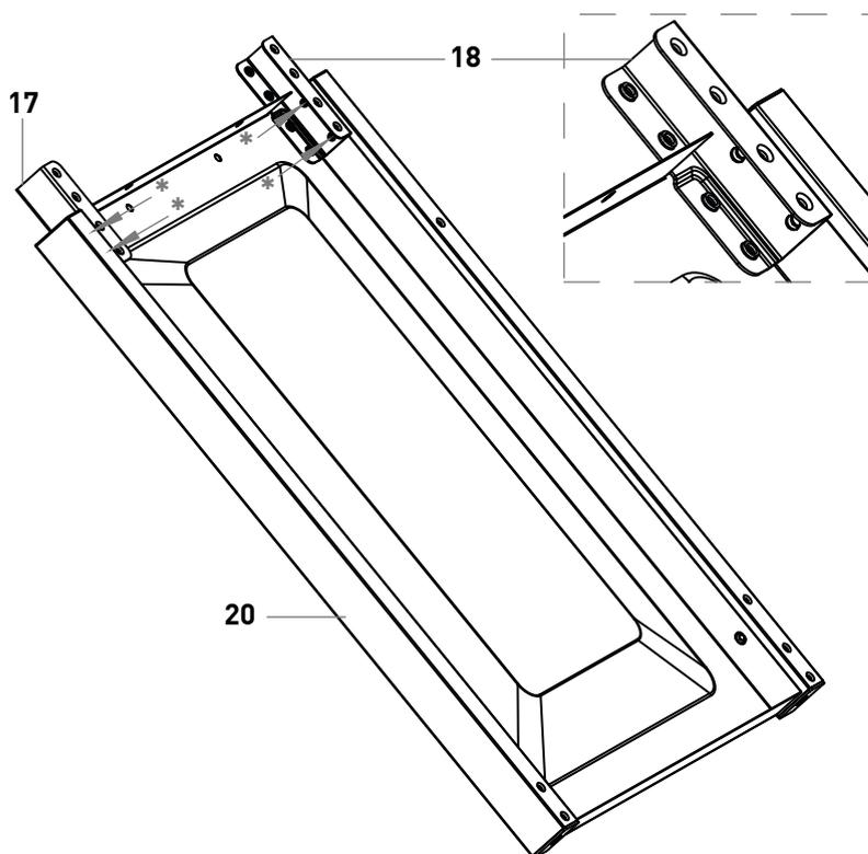
\* Zuerst die Schrauben M6x12 von der Seitenwand entfernen und die Halterungen damit befestigen.
