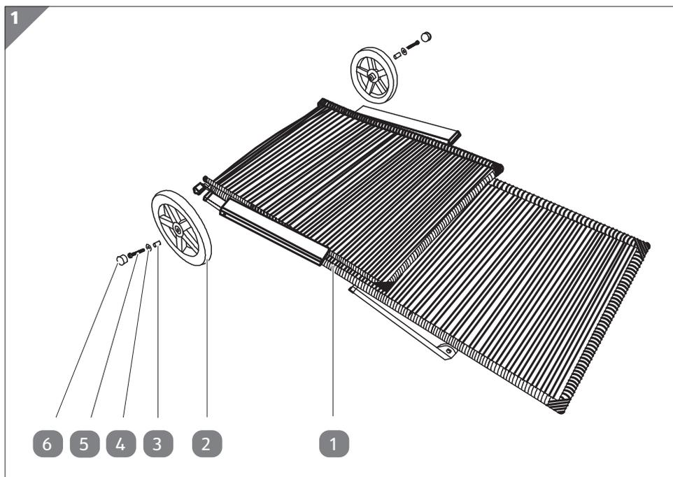
1. Setzen Sie die Räder **2** an das Liegestell **1**. Stecken Sie die Schrauben **5** durch die Unterlegscheiben **4** und Führungslager **3** in die Achsen der Räder (siehe **Abb. 1**). Ziehen Sie die Schrauben mit dem Innensechskantschlüssel **7** fest an.
