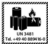
Dieses Symbol kennzeichnet Gefahrgut mit einer Lithium-Ionen-Batterie.
