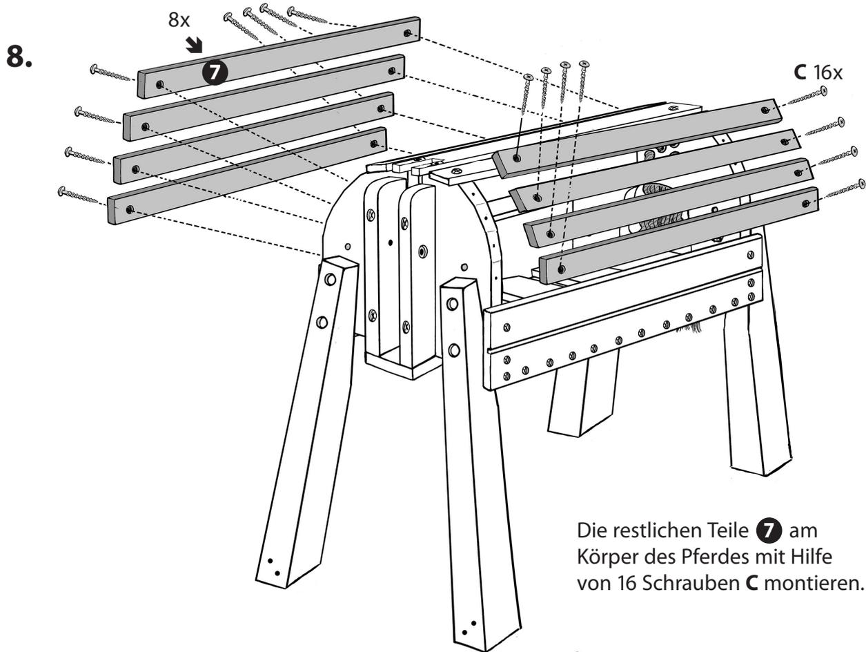
Die restlichen Teile **7** am Körper des Pferdes mit Hilfe von 16 Schrauben **C** montieren.
