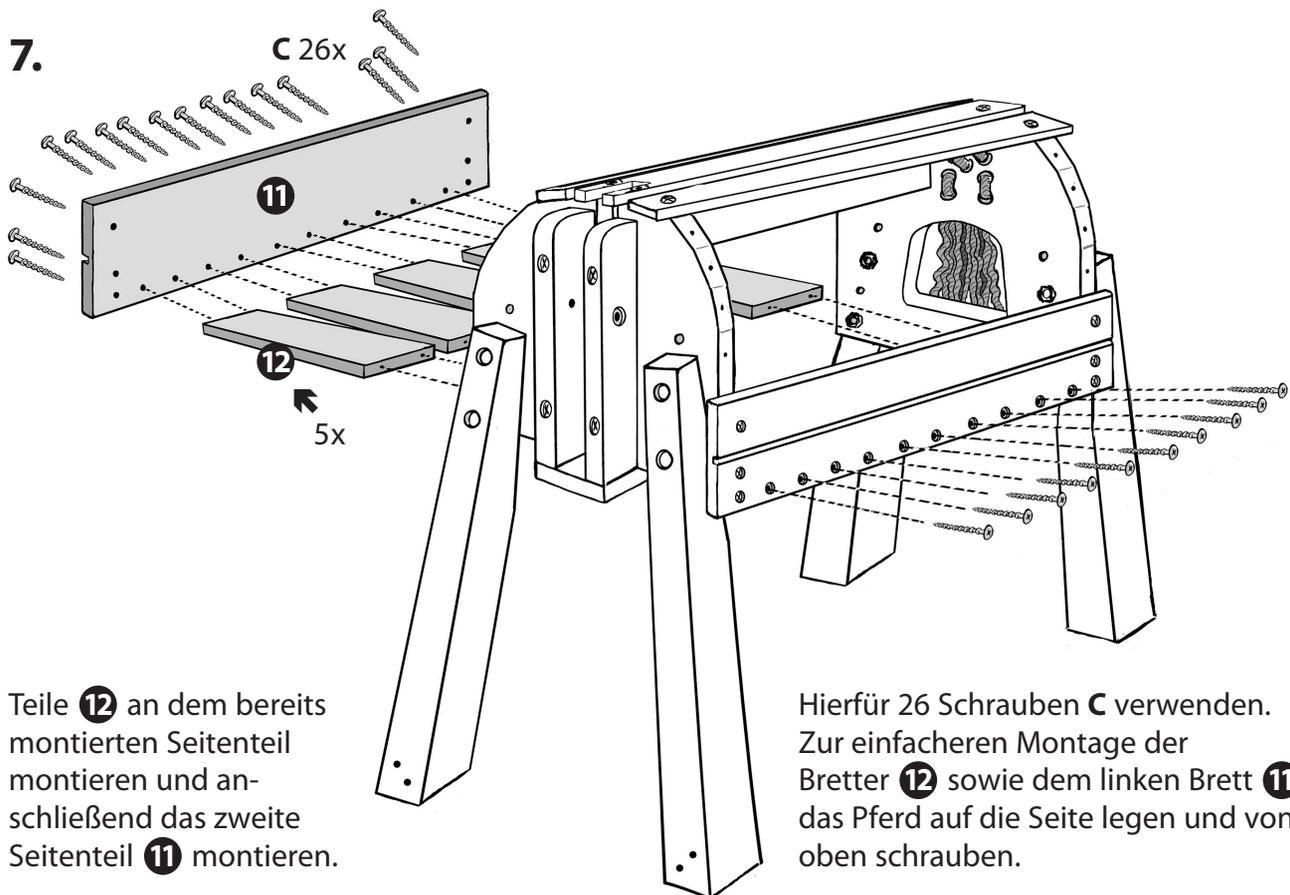
Teile **12** an dem bereits montierten Seitenteil montieren und anschließend das zweite Seitenteil **11** montieren.
