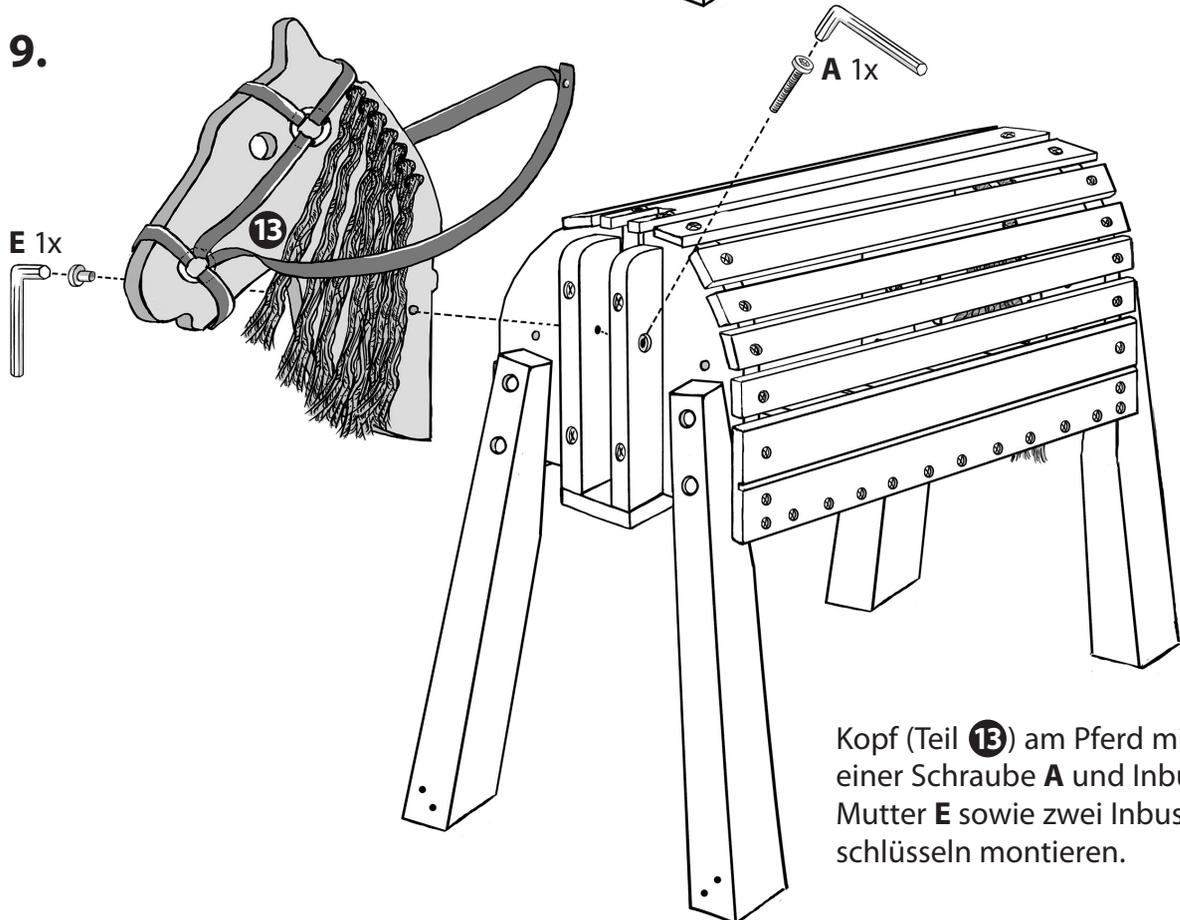
Kopf (Teil **13**) am Pferd mit Hilfe einer Schraube **A** und Inbus-Mutter **E** sowie zwei Inbusschlüsseln montieren.
