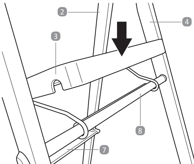
3. Appuyez sur la plateforme **3** au niveau de l'entretoise du haut **8** de manière à ce que la plateforme repose correctement (voir **fig. 1**). Assurez-vous que les deux échancrures de la plateforme soient bien enclenchées sur l'entretoise du haut.
