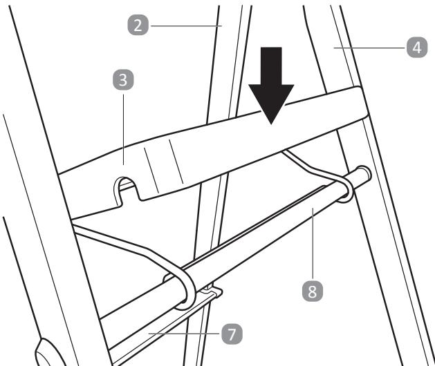
3. Premere la piattaforma **3** sulla traversa superiore **8** in modo che vi sia appoggiata saldamente (vedi **Fig. 1**). Accertarsi che entrambi gli alloggiamenti della piattaforma siano completamente inseriti sulla traversa superiore.
