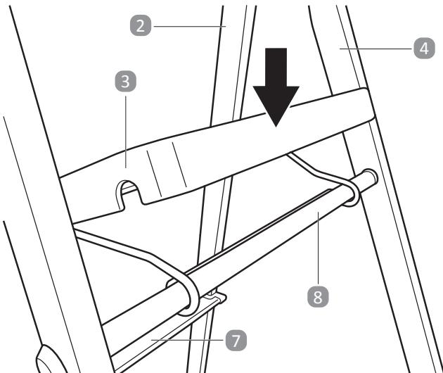
3. Drücken Sie die Plattform **3** auf die obere Querstrebе **8**, sodass die Plattform fest aufliegt (siehe **Abb. 1**). Stellen Sie sicher, dass die beiden Aussparungen der Plattform vollständig auf der oberen Querstrebе eingehakt sind.
