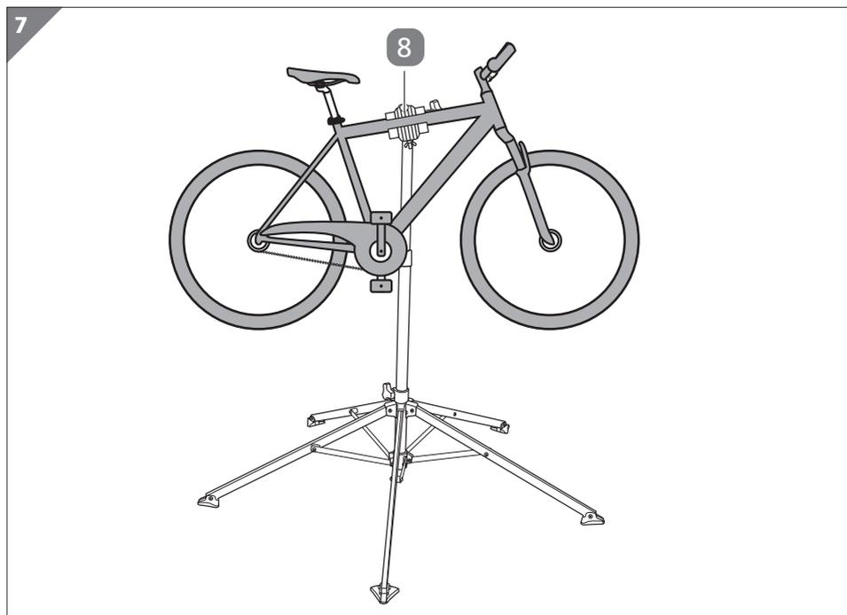
4. Inserire il telaio della bicicletta nel morsetto della bicicletta **8** (vedi **Fig. 7**).
