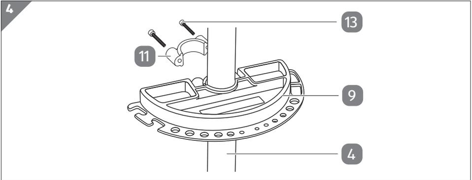
1. Fissare il vassoio di conservazione **9** al treppiede **4** servendosi del morsetto di bloccaggio **11** e di 2 viti **13** (vedi **Fig. 4**).
