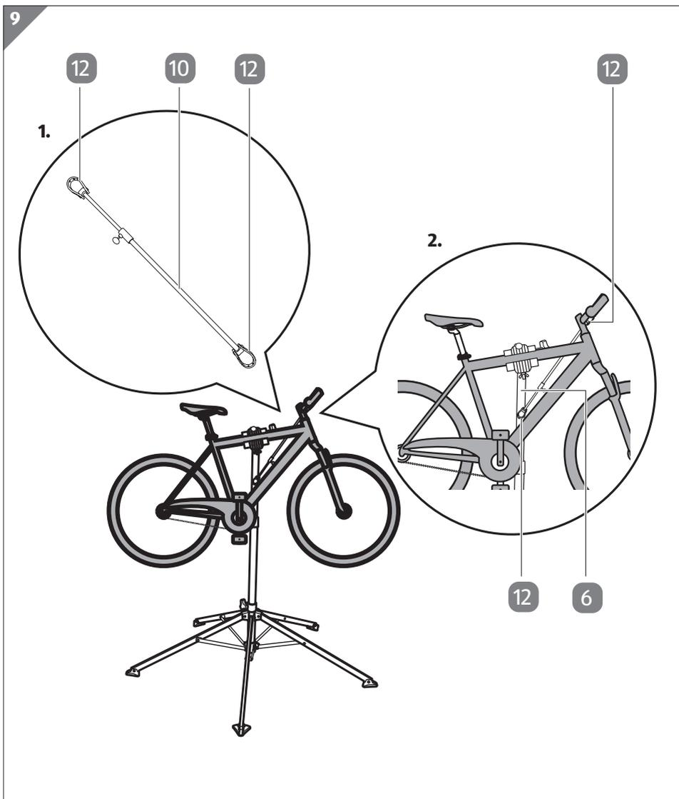
7. Se necessario, usare lo stabilizzatore del manubrio **10** e i morsetti ad anello **12** per fissare il manubrio della bicicletta (vedi **Fig. 9**).
