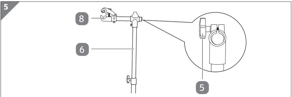
2. Allentare la manopola di bloccaggio **5** sull'asta telescopica **6** e ruotare il morsetto della bicicletta **8** per adeguare l'angolo di serraggio (vedi **Fig. 5**).
