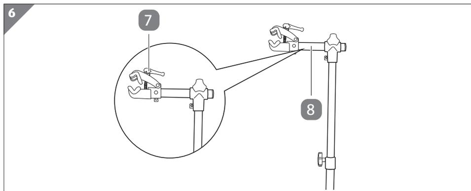
3. Allentare la leva di sgancio rapido **7** aprire la ganaschia di bloccaggio del morsetto della bicicletta **8** (vedi **Fig. 6**).
