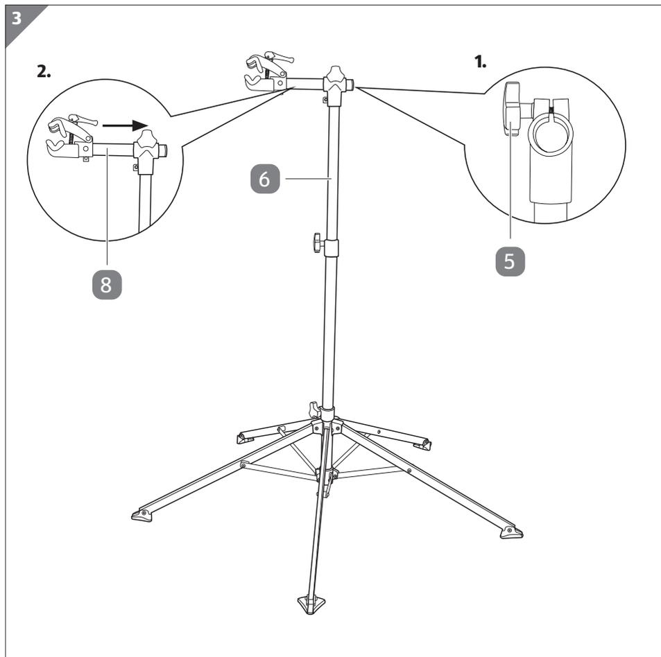
1. Allentare la manopola di bloccaggio **5** sull'asta telescopica **6** (vedi passo 1 nella **Fig. 3**).
