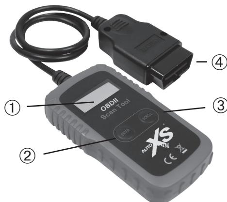
1. **DISPLAY LCD**-- Indica i risultati del test. Si tratta di un dispositivo retroilluminato a 2 righe con 8 caratteri su ogni riga.
