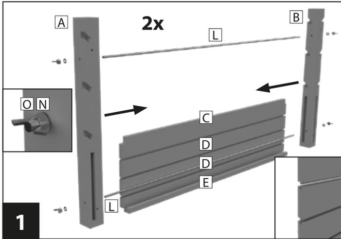
1 Setzen Sie zwischen den beiden Eckpfosten **A** und **B** die Panele lang oben **C**, 2x Mitte **D** und unten **E** ein. Die Panele werden dabei vorab durch Nut und Feder verbunden (siehe Detailbild).
