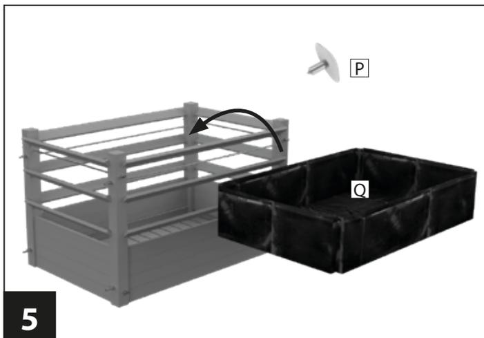
5 Legen Sie die Folie **Q** ein und breiten diese entlang der Konturen aus. Fixieren Sie die Folie am oberen Rand umlaufend und gleichmäßig verteilt mit den Reißzwecken **P**.
