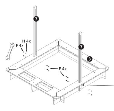
Die verstellbare Dachhalterung mit Hilfe des Maulschlüssels am Sandkastenunterbau montieren.
