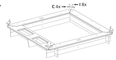
Den Eckschutz an allen vier Ecken montieren.
