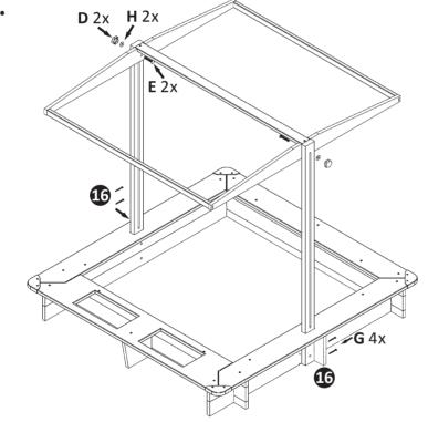
Das zusammengebaute Dach an der Dachhalterung montieren.
