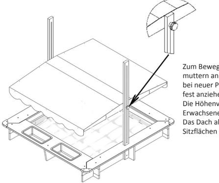
Zum Bewegen des Daches die Sterngriffmuttern an beiden Seiten etwas lösen und bei neuer Position die Sterngriffmuttern fest anziehen.
