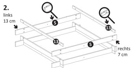
Die weiteren Teile des Sandkastenunterbaus aufstecken.
