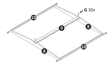
Die nebenstehend abgebildeten Teile des Daches zusammenmontieren. Hinweis: Die Bohrungen der Bretter to müssen nach außen zeigen.
