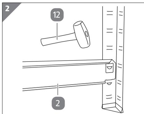
1. Fissare le barre inferiori il più vicino possibile al pavimento. Utilizzare un martello **12** per inserire le barre trasversali **2** nella parte inferiore dei supporti **6** (vedi **Fig. 2**).
