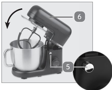
**Avvertenza:** se il braccio di azionamento 6 non è nella posizione inferiore, l'apparecchio non funziona. Se il braccio di azionamento 6 non dovesse essere bloccato correttamente e quindi durante il funzionamento dovesse ribaltarsi verso l'alto, l'apparecchio interrompe immediatamente il funzionamento. In entrambi i casi sul display compare lampeggiante il messaggio di errore "E :01".
