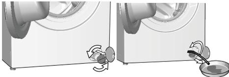
4 Reinigen Sie den Filter sorgfältig von sämtlichen Rückständen und entfernen Sie sämtliche Textilfasern (sofern vorhanden) in der Nähe der Pumpenflügel.
