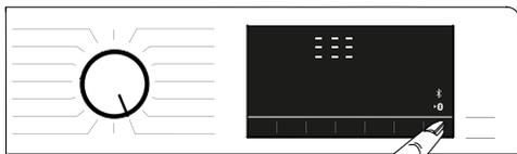
Wenn die Fernbedienung aktiviert ist, können Sie die Maschine nur verwalten, ausschalten und den Status über Ihre Waschmaschine verfolgen. Über die Anwendung können alle Vorgänge mit Ausnahme der Kindersicherung ausgeführt werden.
