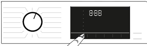
Nachdem ein Programm ausgewählt wurde, wird die empfohlene Schleuderdrehzahl des gewählten Programms in der Anzeige Schleuderdrehzahl dargestellt. Möglicherweise ist die empfohlene Schleuderdrehzahl nicht die Maximalschleuderdrehzahl, die beim aktuellen Programm ausgewählt werden kann.
