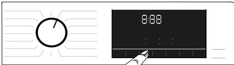
Wählen Sie die gewünschten Hilfsfunktionen aus, bevor Sie das Programm starten. Bei Auswahl eines Programms leuchten die Symbole der kompatiblen Zusatzfunktionssymbole auf.
