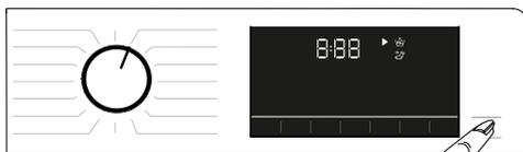
Falls der Wasserstand in der Maschine bei Betätigung der Taste Start/Pause zu hoch ist, kann die Türsperre nicht deaktiviert werden und das Türverriegelungssymbol im Display bleibt eingeschaltet.
