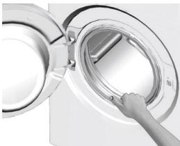
Achten Sie nach jeder Wäsche darauf, dass keine Fremdkörper im Produkt zurückbleiben. Falls die in der Abbildung gezeigten Öffnungen in der Gummidichtung verstopft sein sollten, entfernen Sie die Verstopfung mit einem Zahnstocher.
