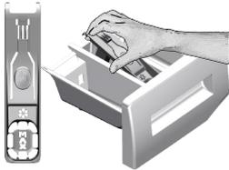
Reinigen Sie die Waschmittelschublade in regelmäßigen Abständen (alle 4 bis 5 Wäschen) wie unten beschrieben, um die Ansammlung von Waschpulver zu verhindern. Reinigen Sie den Siphon, wenn überschüssige Mengen an Wasser und Weichspüler im Weichspülerfach verbleiben.
