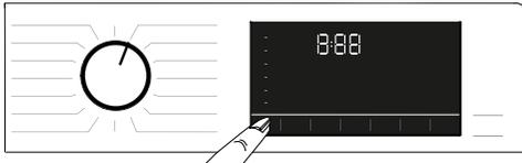
Sobald Sie ein neues Programm auswählen, wird die für das jeweilige Programm empfohlene Waschtemperatur in der Temperaturanzeige angezeigt. Möglicherweise ist die empfohlene Temperatur nicht die Maximaltemperatur, die beim aktuellen Programm ausgewählt werden kann.
