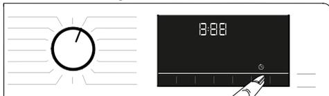
Damit die Endzeitfunktion aktiviert und das Programm nach Ablauf der angegebenen Zeit abgeschlossen wird, müssen Sie nach Anpassung der Zeit die Start/Pause-Taste drücken.
