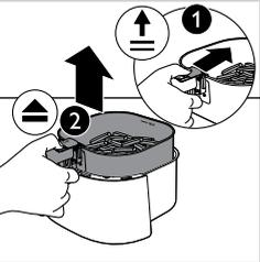
**11** Um kleine Zutaten (z. B. Pommes frites) herauszunehmen, heben Sie den Korb aus der Pfanne, indem Sie zunächst die Abdeckung der Korbtriegelungstaste in Richtung des Airfryers schieben und die Taste nach unten drücken.
