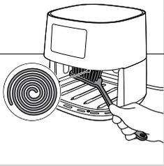
5 Reinigen Sie das Heizelement mit einer Reinigungsbürste, um etwaige Lebensmittelrückstände zu entfernen.
