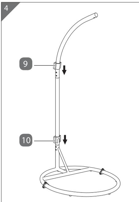
– Schieben Sie die Abdeckungen **9** und **10** runter, um die Verbindungs­löcher abzudecken.
