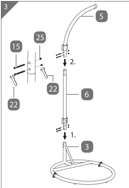
1. Stecken Sie die Stange **6** in den Standfuß **3** und befestigen Sie sie mit zwei Schrauben **15** und vier Muttern **25** (siehe Schritt 1).
