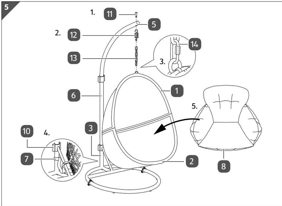
1. Stecken Sie den Federbolzen **11** von oben in das Verbindungsloch des Arms **5** (siehe Schritt 1).
