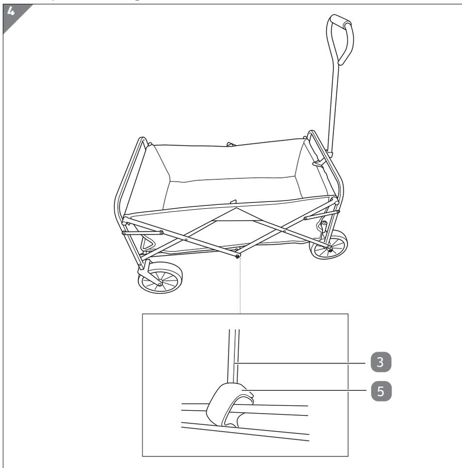
7. Fissare le linguette in velcro della borsa di tela **5** al fondo del telaio assemblato **3** (vedi **Fig. 4**).
