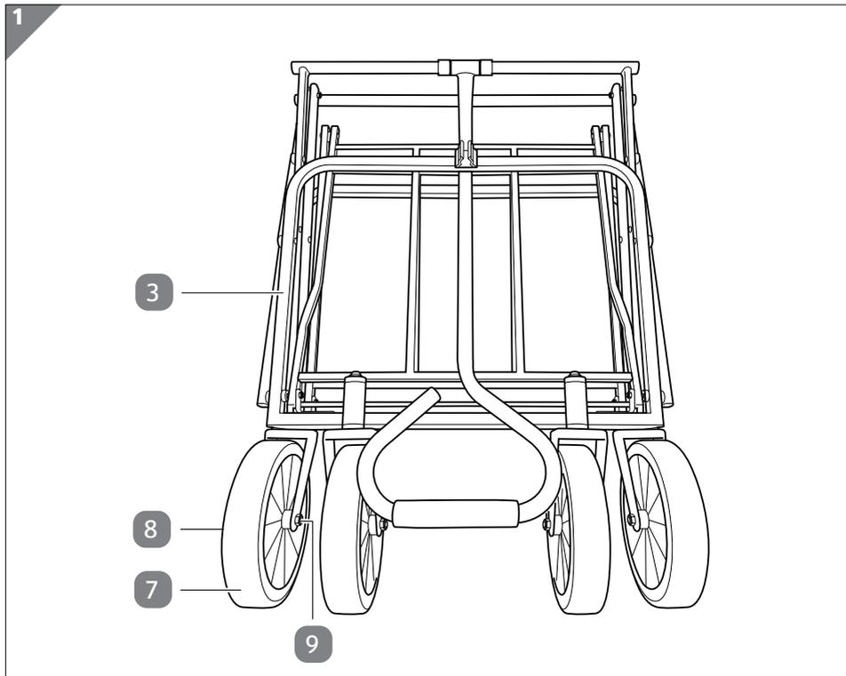
1. Montare la ruota **7** utilizzando una vite **9** e un dado **8** per fissarla al telaio **3** (vedi **Fig. 1**). Serrare a fondo la vite utilizzando una chiave a forchetta **10**.
