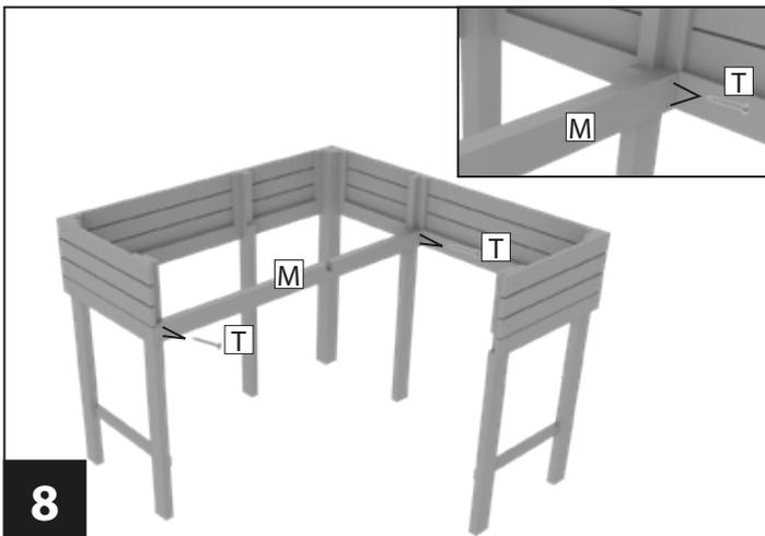
Setzen Sie in eine Mittelstrebe **M** ein.
