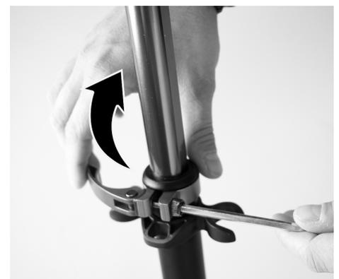
Allentare la leva di serraggio del tubo di direzione. Premere il bottone di sicurezza e tenerlo premuto. Tirate il tubo di direzione fino alla posizione desiderata. Stringere la leva di serraggio per fissare il tubo di direzione.
