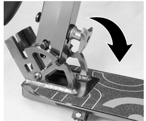
Spannhebel öffnen. Sicherungshebel nach oben drücken und gedrückt halten. Lenkrohr in aufrechte Position ziehen. Lenkrohr wieder mit Spannhebel sichern
