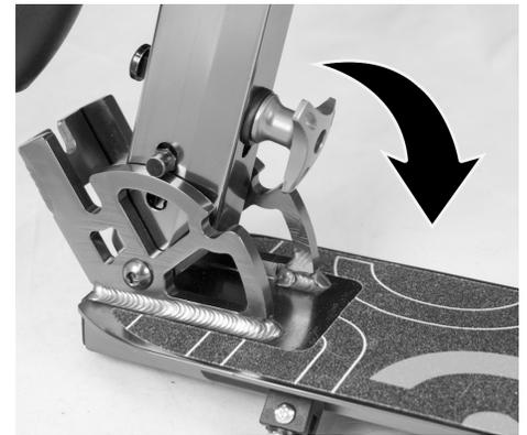
Ouvrir le levier de serrage – lever vers le haut le levier de serrage en le maintenant fermement – tirer sur le tube de direction jusqu'à la position adéquate – Verrouiller à nouveau le levier de serrage
