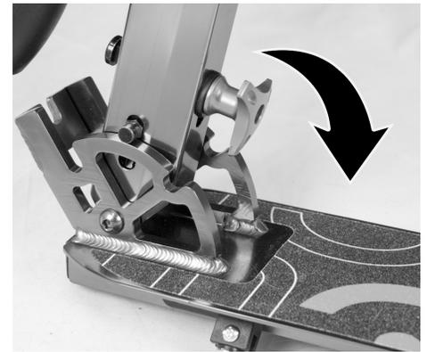
Allentare la leva di serraggio. Spingere in alto la leva di sicurezza e tenerla ferma. Alzare il tubo di direzione fino alla posizione verticale. Stringere la leva di serraggio.
