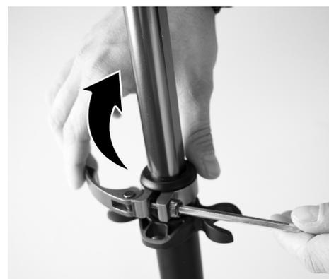
Otpustite zateznu polugu upravljača. Pritisnite i držite pritisnutim sigurnosni gumb. Izvucite cijev upravljača na visinu koju želite. Zateznu polugu potom zategnite kako biste pričvrstili upravljač.
