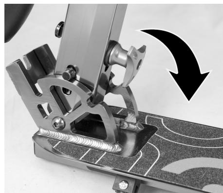
Otevřete upínací páku (tahejte směrem ven) - Zatlačte upínací páku směrem dolů a držte ji - Potáhněte volant pomocí druhé ruky do stejné polohy - Upevněte volant upínací pákou
