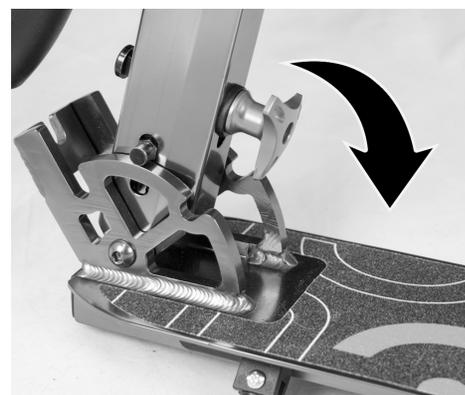
Odprite zategovalni vzvod (potegnite navzven) - Pritisnite varovalni vzvod navzdol in ga zadržite v tem položaju - Krmilno cev dajte z drugo roko v pokončni položaj - Spet zavarujte krmilno cev z zategovalnim vzvodom
