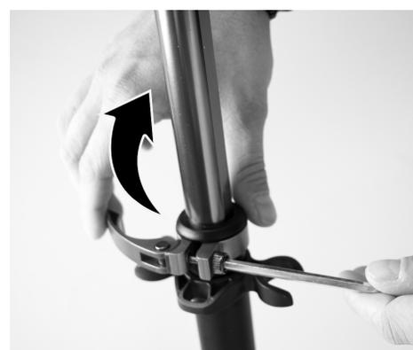
Sprostite zategovalni vzvod krmilne cevi - Pritisnite varovalni gumb in ga zadržite v tem položaju - Izvlecite krmilno cev do zelene višine - Spet potegnite zategovalni vzvod, da boste pritrdili krmilno cev
