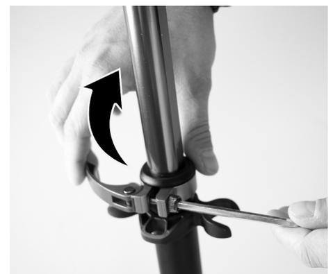
Desserrer le levier de serrage du tube de direction – pressez sur le bouton de sécurité et le maintenir – tirez le tube de direction jusqu'à la hauteur désirée. Resserrer le levier de serrage et fixer le tube de direction
