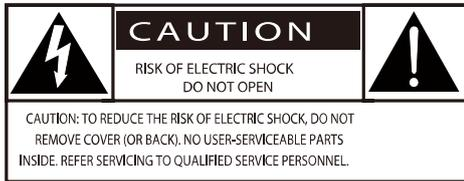
Dieses "Blitz"-Symbol weist darauf hin, dass nicht isoliertes Material innerhalb des Geräts einen elektrischen Schlag verursachen kann. Zur Sicherheit aller Personen in Ihrem Haushalt entfernen Sie bitte die Abdeckung nicht. Das "Ausrufezeichen" weist auf Details hin, für die Sie die beiliegende Literatur aufmerksam lesen sollten, um Probleme bei der Bedienung und Wartung zu vermeiden.
