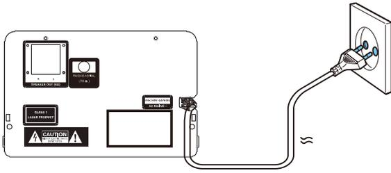
Schließen Sie das Netzkabel an die Netzsteckdose an.
