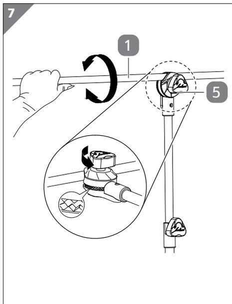
1. Drehen Sie die Schraube **5** gegen den Uhrzeigersinn in Richtung „+“ auf.
