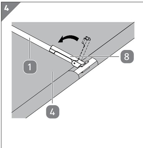
1. Schließen Sie die Aufnahme mit Hebel **8** durch Herunterdrücken des Hebels. Die Blende **4** wird nun gespannt.
