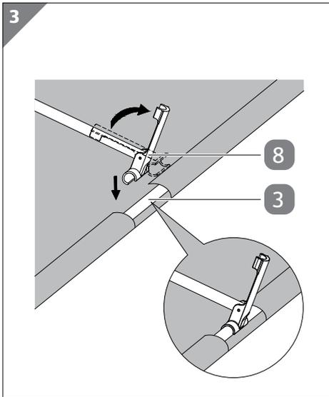
1. Öffnen Sie die Aufnahme mit Hebel **8**.
