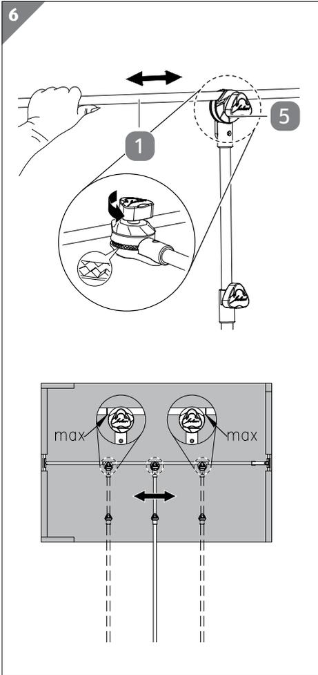
1. Drehen Sie die Schraube **5** gegen den Uhrzeigersinn in Richtung „+“ auf.
