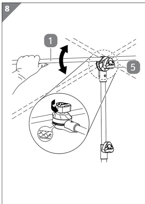
1. Drehen Sie die Schraube **5** gegen den Uhrzeigersinn in Richtung „+“ auf.
