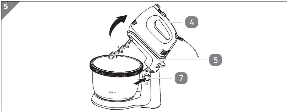
7. Drücken Sie die Halterungsverriegelungstaste **7**, um die Halterung **5** zu entriegeln. Klappen Sie dann die Haupteinheit **4** nach oben, bis die Halterung mit einem Klicken einrastet und die Taste zurück in ihre ursprüngliche Position springt (siehe **Abb. 5**). Nehmen Sie die Rührschüssel **11** aus der Schüsselablage. Drücken Sie die Entriegelungstaste **6**, um die Haupteinheit von der Halterung zu entfernen.
