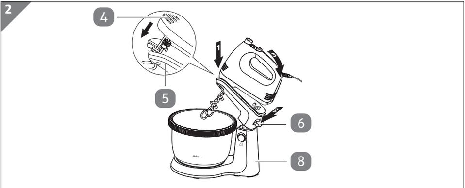
5. Befestigen Sie die Haupteinheit **4** wieder an der Halterung **5**. Halten Sie dazu die Haupteinheit leicht nach vorne geneigt und setzen Sie erst den vorderen, dann den hinteren Teil auf der Basisstation **8** auf. Halten Sie die Entriegelungstaste **6** gedrückt, bis die Haupteinheit vollständig aufliegt (siehe **Abb. 2**).
