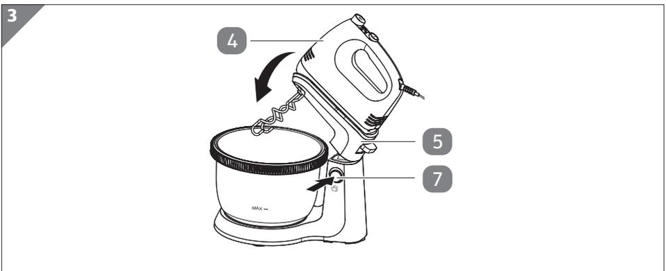
6. Drücken Sie die Halterungsverriegelungstaste **7** und senken Sie dann die Haupteinheit **4** vorsichtig ab, bis die Halterung **5** mit einem Klicken einrastet und die Taste zurück in ihre ursprüngliche Position springt (siehe **Abb. 3**).
