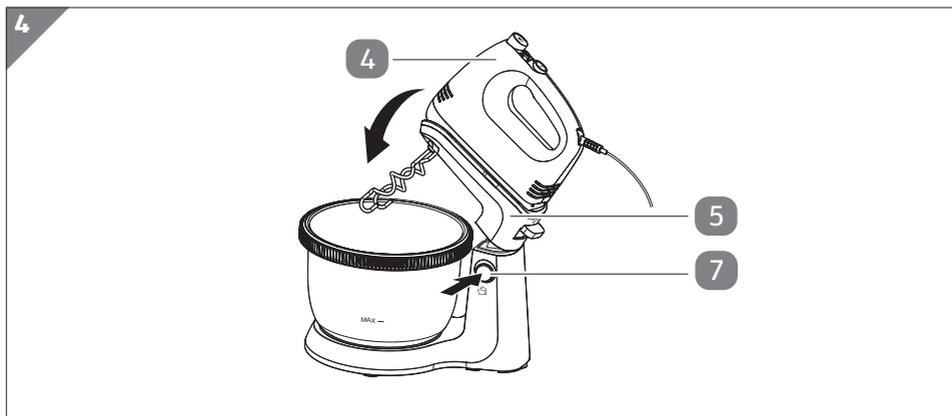
3. Drücken Sie die Halterungsverriegelungstaste **7** und senken Sie dann die Haupteinheit **4** vorsichtig ab, bis die Halterung **5** mit einem Klicken einrastet und die Taste zurück in ihre ursprüngliche Position springt (siehe **Abb. 4**).
