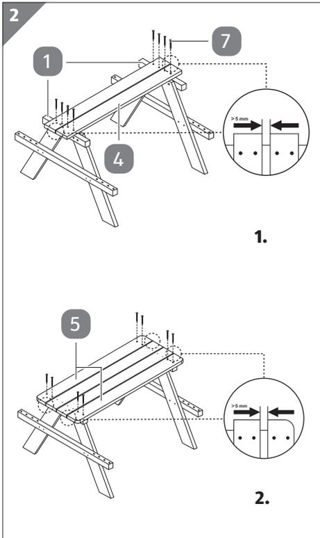
1. Befestigen Sie die viereckigen Bretter **4** mit den Schrauben  $3,5 \times 45$  **7** mittig an der kurzen Querstrebe **1** (siehe Schritt 1 in **Abb. 2**).
