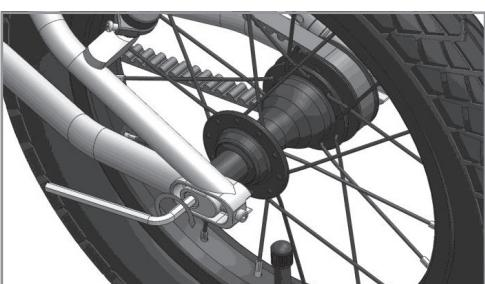
9. Wenn die richtige Spannung und Ausrichtung erreicht ist, stellen Sie sicher, dass die Hinterradschrauben auf der Antriebsseite (rechte Seite) und der Nicht-Antriebsseite (linke Seite) mit 8 Nm angezogen werden.
