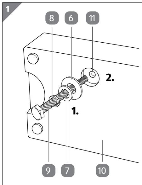
1. Posizionare la base in granito **10** perpendicolarmente e tenerla saldamente.
