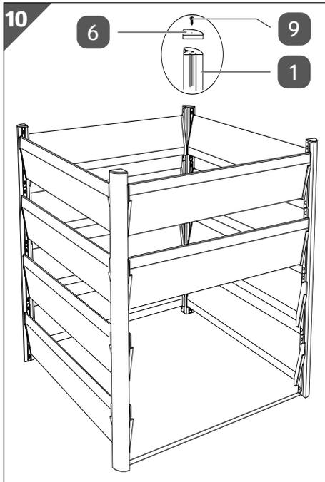
1. Setzen Sie eine Kunststoff-Deckelkappe **6** oben auf einen der Eckpfosten **1**.
