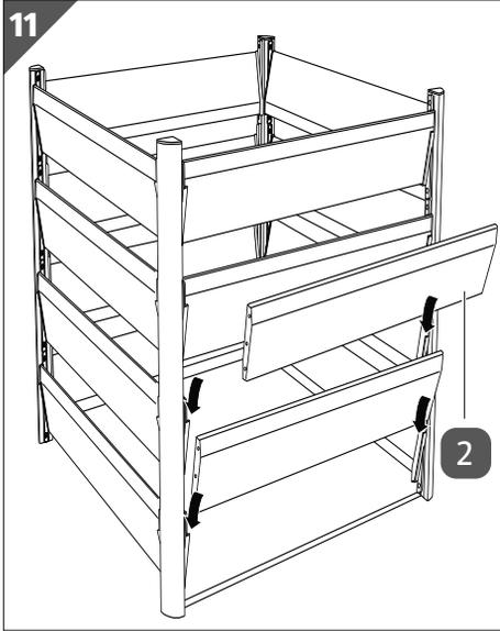
1. Schieben Sie eine der verbliebenen Aluminiumplanken **2** in 2 gegenüberliegende Steckprofile **4** / **5**, die Sie bereits an den vorderen Eckpfosten **1** montiert haben.
