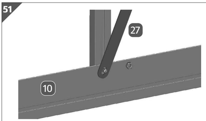
9. Stecken Sie die Wandstrebe in das Bodenprofil (10).
