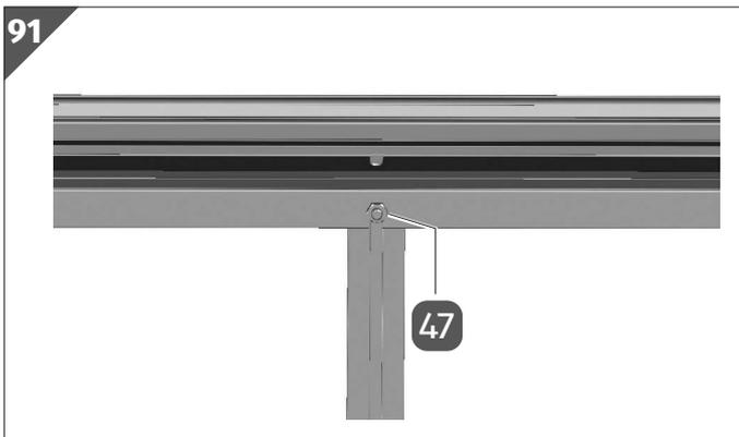
11. Fixieren Sie die Schraube M6/12 mit einer Mutter **47**.
