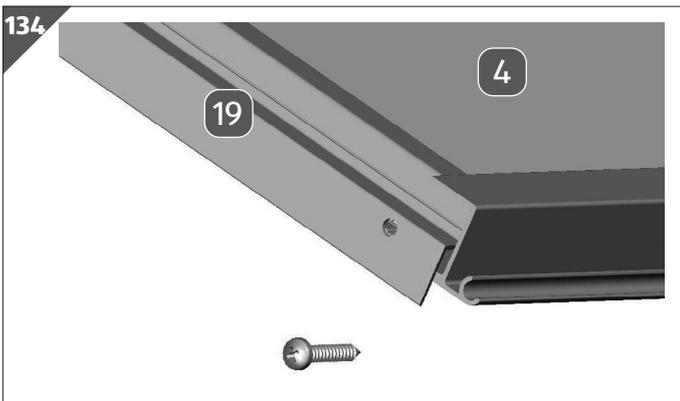
7. Legen Sie das seitliche Fensterprofil **19** an das Scharnierprofil **18**.
