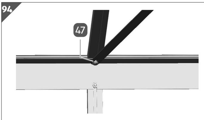
15. Fixieren Sie die Schraube M6/12 mit einer Mutter (47).
