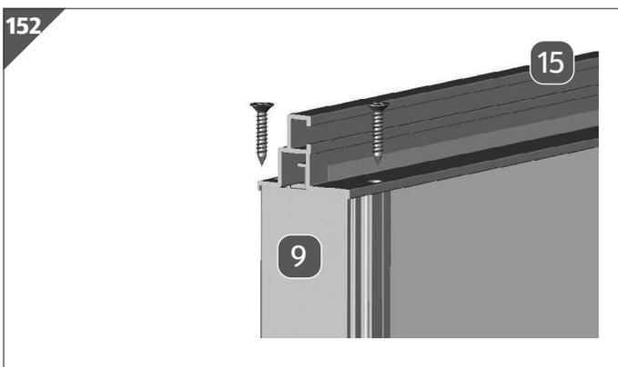
11. Legen Sie das Türeingangs/Türseitenprofil **9** an das Türrollenprofil **15**.
