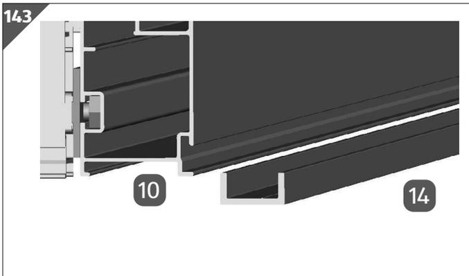
2. Stecken Sie die untere Türschiene **14** in das Bodenprofil **10**. Hängen Sie dafür einen Schenkel der Türschiene im Bodenprofil ein. Drücken Sie die Türschiene so weit nach oben, bis die Türschiene auch an der Unterseite im Bodenprofil eingehängt werden kann.
