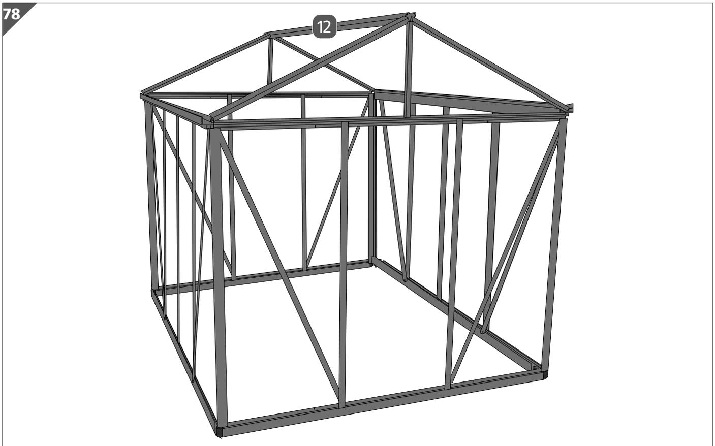
Im folgenden Bauabschnitt wird der First **12** angebracht.
