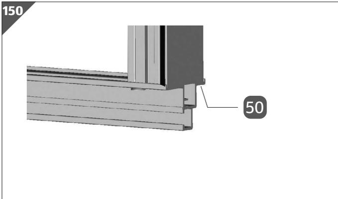
9. Befestigen Sie das Türrollenprofil mit zwei Blechschrauben Senkkopf 4,2×22 mm **50** am Türeingang/Türseitenprofil.
