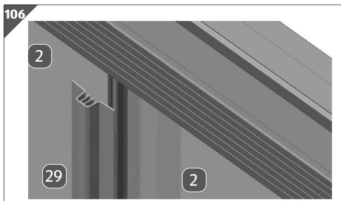
2. Stecken Sie die Kunststoff-Clipprofile, Seitenwand **29** auf die Streben zwischen den Stegplatten **2**.
