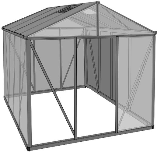
3. Stecken Sie die das Türeingang/Türseitenprofil auf die Stegplatte und befestigen Sie es wieder mit den Muttern.
