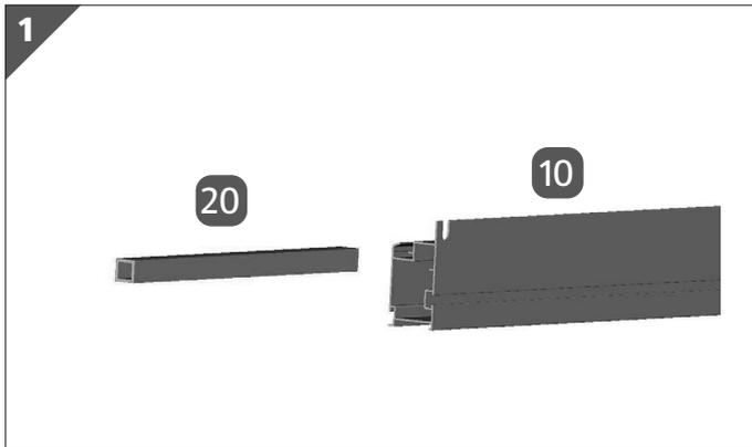
1. Stecken Sie den Verbinder 15×15 mm **20** in das Bodenprofil **10**.
