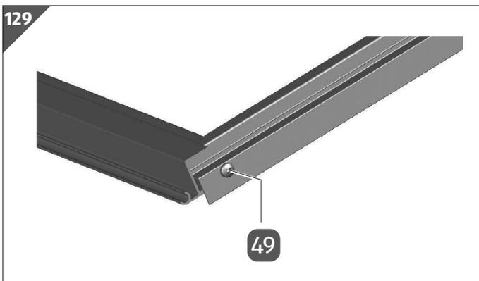
3. Befestigen Sie das Fensterprofil mit einer Blechschraube 4,2×22 mm **49** am Scharnierprofil.
