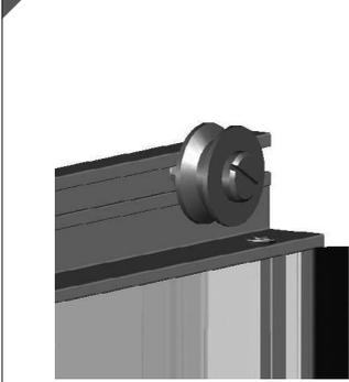
17. Verschrauben Sie den Achsbolzen mit der Mutter.
