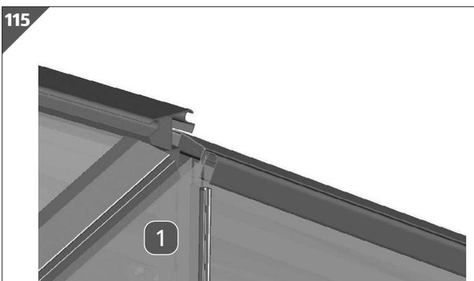
3. Setzen Sie eine Dreiecksplatte **1** auf der anderen Seite an die Dachstütze an.
