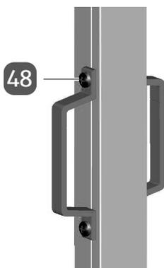
4. Befestigen Sie die Türgriffe mit den Bohrschrauben 4,8×13 mm **48** am Türeingang/Türseitenprofil.
