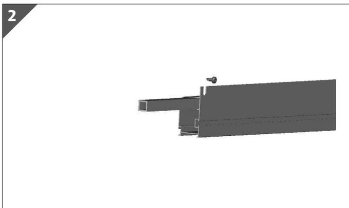
2. Stellen Sie sicher, dass der Verbinder 125 mm aus dem Bodenprofil herausragt.
