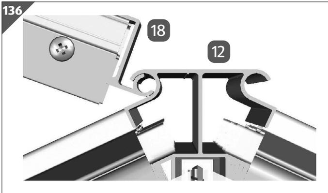
9. Stecken Sie das Scharnierprofil **18** seitlich in der First **12** hinein. Schieben Sie das Fenster anschließend vom Ende des Firstprofils an die gewünschte Position.
