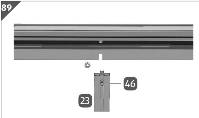
9. Stecken Sie eine Schrauben M6/12 **46** in die Dachstrebe **23**.
