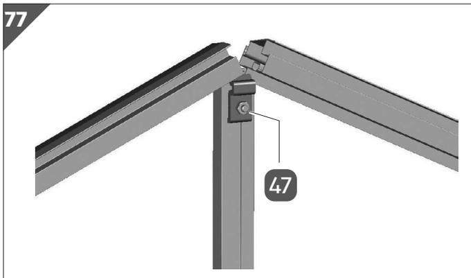
10. Fixieren Sie die Schraube M6/12 mit einer Mutter **47**.
