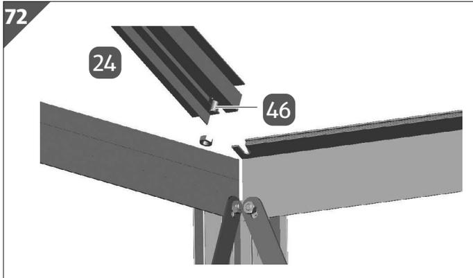
4. Stecken Sie eine Schraube M6/12 **46** in das Giebeleckprofil **24**.
