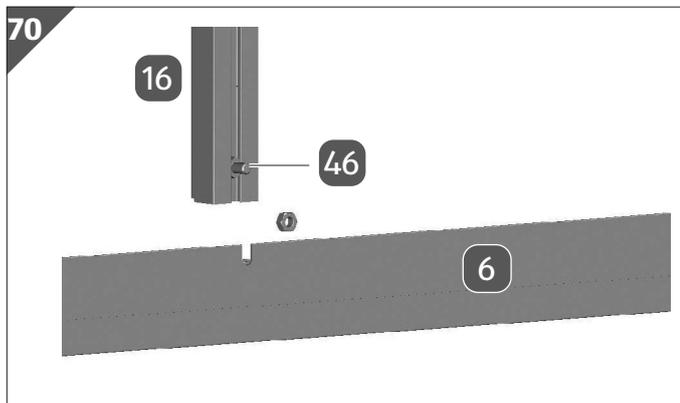
1. Stecken Sie eine Schraube M6/12 (46) in die Dachstütze (16).
