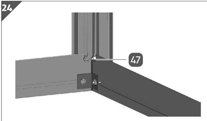
3. Fixieren Sie beiden Schrauben M6/12 mit den Muttern **47**.
