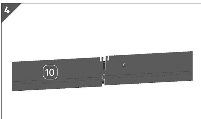
4. Stecken Sie ein zweites Bodenprofil **10** auf den Verbinder.
