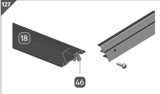
1. Stecken Sie die beiden Schrauben M6/12 **46** in das Scharnierprofil **18**.
