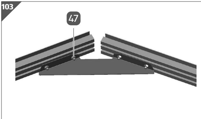
5. Platzieren Sie die Verstärkung **21** auf den Schraube M6/12.
