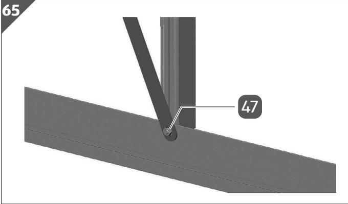
7. Fixieren Sie die Schraube M6/12 mit einer Mutter **47**.
