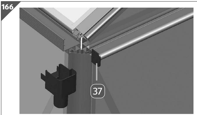
2. Stecken Sie den Türschienenschutz **37** an beiden Seiten in die Türschiene.
