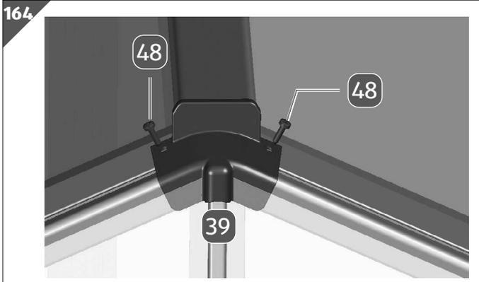
1. Befestigen Sie die Abdeckkappe **39** mit den Bohrschrauben 4,8×13 mm **48** am First.
