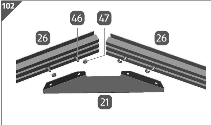
4. Lösen sie die Muttern an den beiden Kopplastreben **26** am First.
