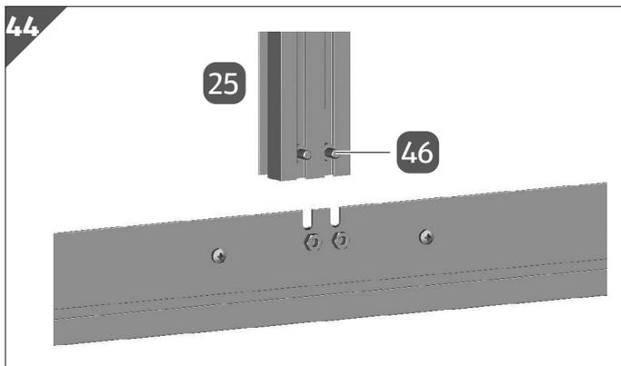
1. Stecken Sie zwei Schrauben M6/12 **46** in die Koppelstrebe für die Wand **25**.
