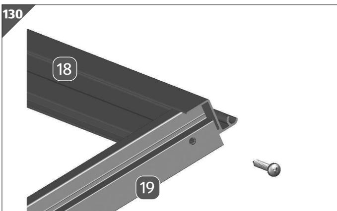
4. Legen Sie das zweite (obere) Scharnierprofil **18** an das Fensterprofil **19**.
