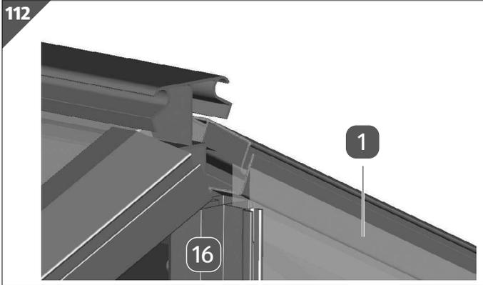
1. Setzen Sie eine Dreiecksplatte **1** an die Dachstütze **16** an.
