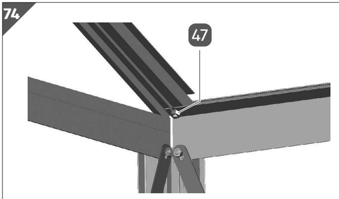
6. Fixieren Sie die Schraube M6/12 mit einer Mutter **47**.
