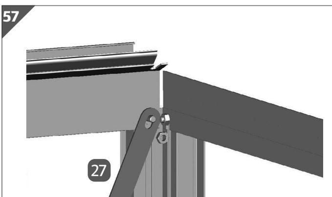
16. Platzieren Sie einen Windverband **27** auf der Schraube M6/12.
