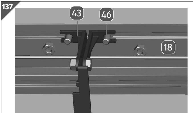
10. Stecken Sie den Fensteraufsteller **43** auf die Schrauben M6/12 **46** im Scharnierprofil **18**.
