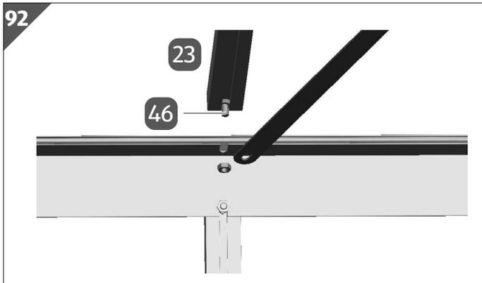
12. Stecken Sie eine Schrauben M6/12 (46) in die Dachstrebe (23).
