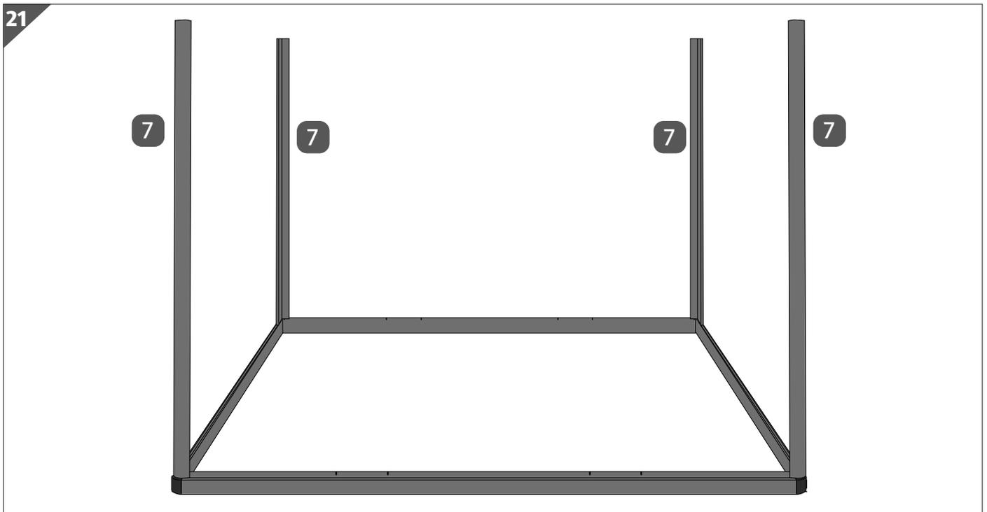
Im folgenden Bauabschnitt werden die Seiteneckprofile **7** angebracht.
