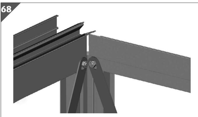
10. Fixieren Sie die Schraube M6/12 wieder mit einer Mutter.
