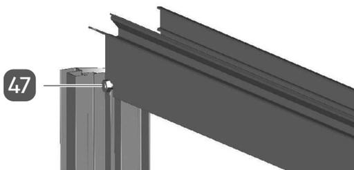
3. Fixieren Sie die Schraube M6/12 mit einer Mutter (47).
