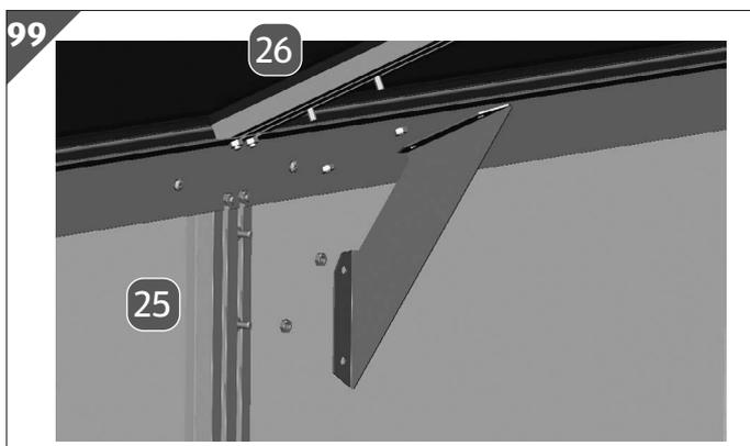
1. Lösen sie die Muttern an den beiden Koppelstreben **25** und **26**.
