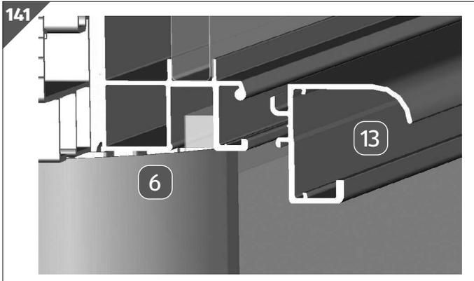
1. Stecken Sie die obere Türschiene **13** in die Querstrebe **6**. Hängen Sie dafür die obere Nase der Türschiene in der Querstrebe ein. Drücken Sie die Türschiene so weit nach oben, bis die untere Nase in der Querstrebe eingehängt werden kann. Anschließend wird die Türschiene ganz nach unten gedrückt.
