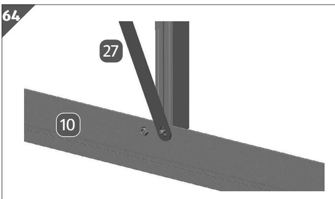
5. Stecken Sie das Türeingang/Türseitenprofil in das Bodenprofil **10**.
