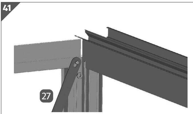
9. Platzieren Sie einen Windverband **27** auf der Schraube M6/12.
