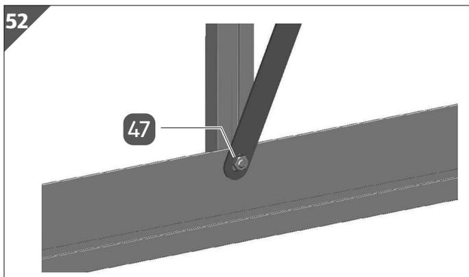
11. Fixieren Sie die Schraube M6/12 mit einer Mutter (47).
