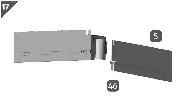
3. Stecken Sie eine Schraube M6/12 (46) in das zweite Bodenprofil (5).
