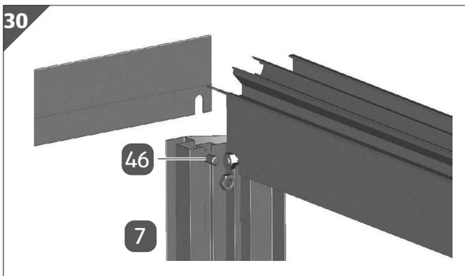
1. Stecken Sie eine Schraube M6/12 **46** in das Seiteneckprofil **7**.
