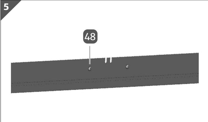
5. Fixieren Sie das Bodenprofil mit einer Bohrschraube 4,8×13 mm **48**.
