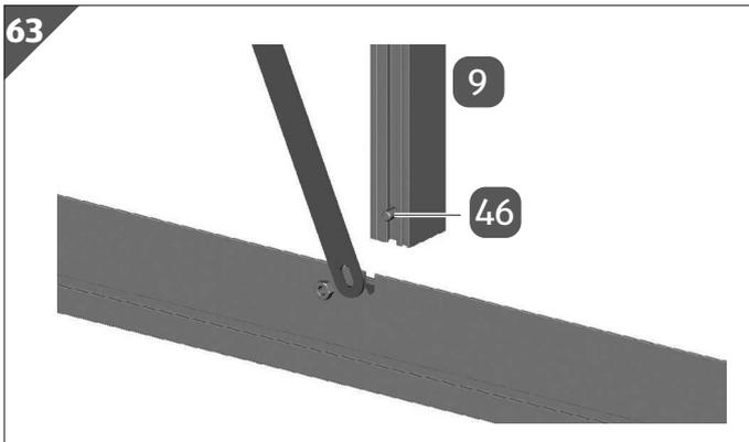
4. Stecken Sie eine Schraube M6/12 **46** in das Türeingang/Türseitenprofil **9**. Stellen Sie sicher, dass die offene Seite des Türeingang/Türseitenprofils nach außen zeigt.
