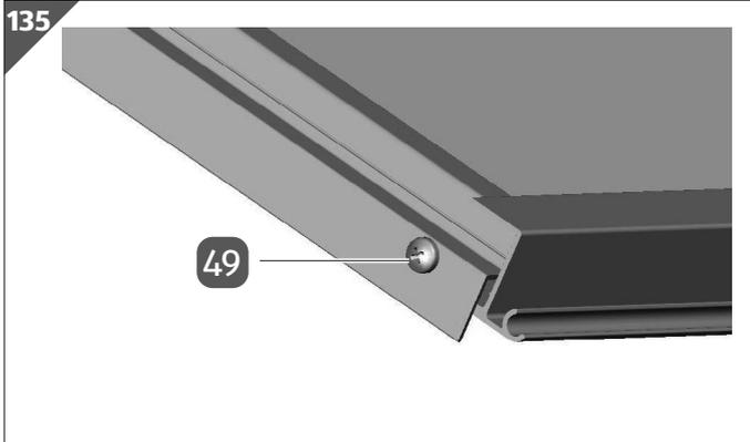
8. Befestigen Sie das Fensterprofil mit jeweils einer Blechschraube  $4,2 \times 22$  mm **49** an den beiden Scharnierprofilen.
