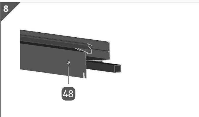
3. Fixieren Sie den Verbinder mit einer Bohrschraube 4,8×13 mm **48**.
