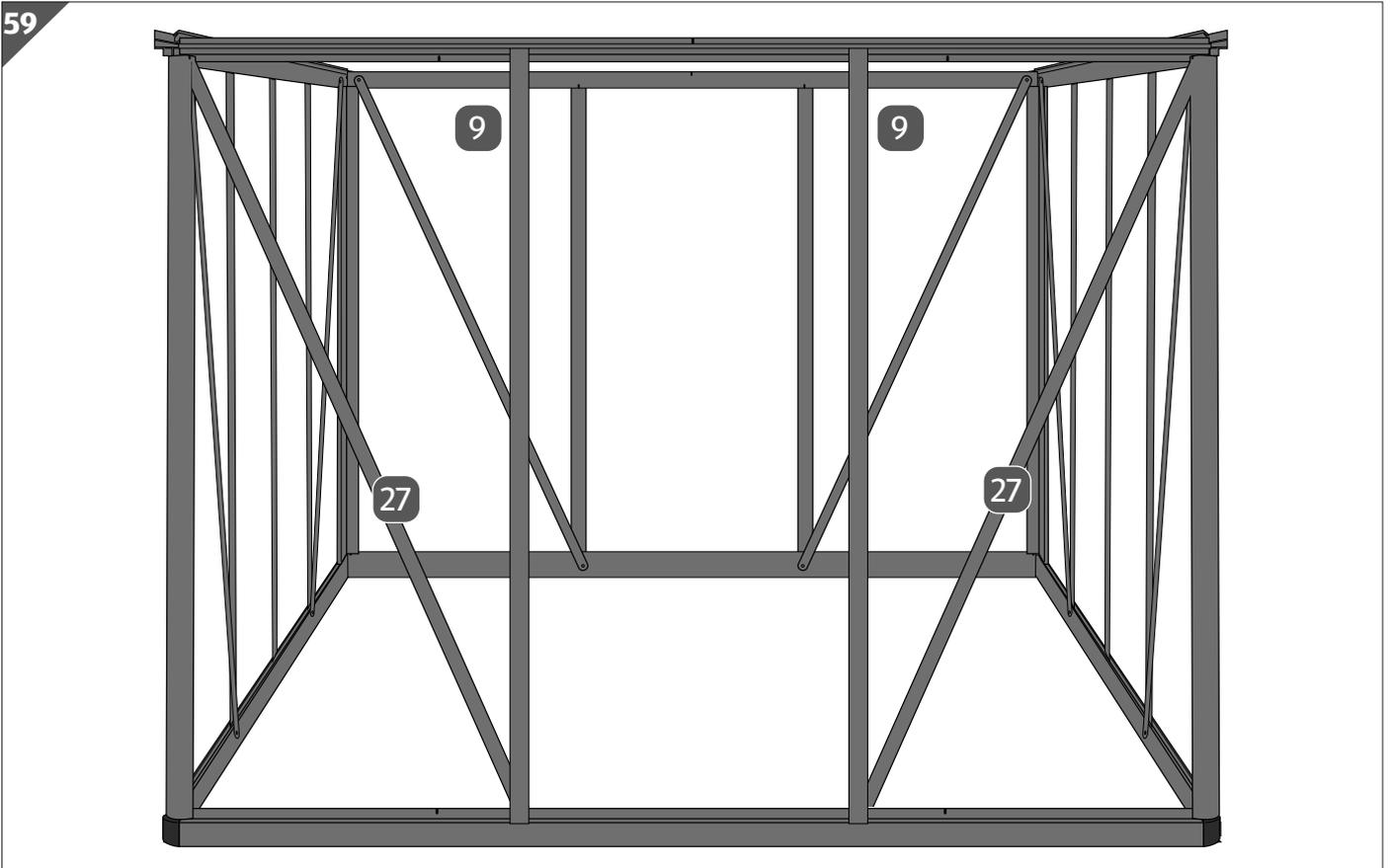
Im folgenden Bauabschnitt werden die Türeingangsprofile und die Windverbände an der Frontwand angebracht.
