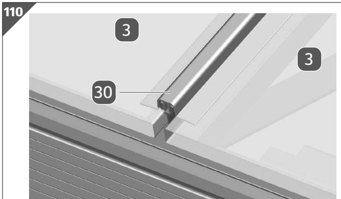
3. Stecken Sie die Kunststoff-Clipprofile **30** auf die Streben zwischen den Dachplatten **3**.
