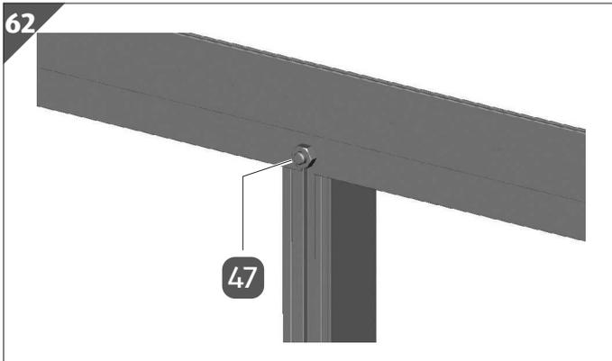
3. Fixieren Sie die Schraube M6/12 mit einer Mutter **47**.
