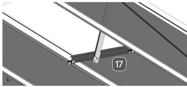
12. Um das Fenster im geöffneten Zustand zu arretieren, stecken Sie den Fensteraufsteller **18** in das Fensteranschlagprofil **17**.
