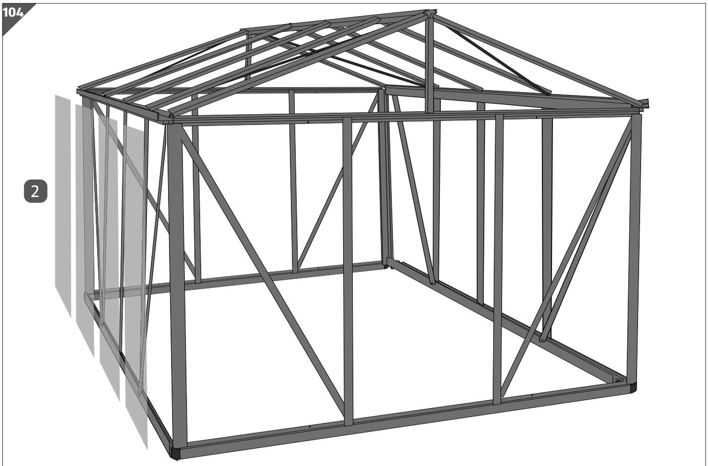
Im folgenden Bauabschnitt werden die Stegplatten **2** Ihres Gewächshauses vorbereitet und in den vorbereiteten Aluminiumrahmen eingesetzt.
