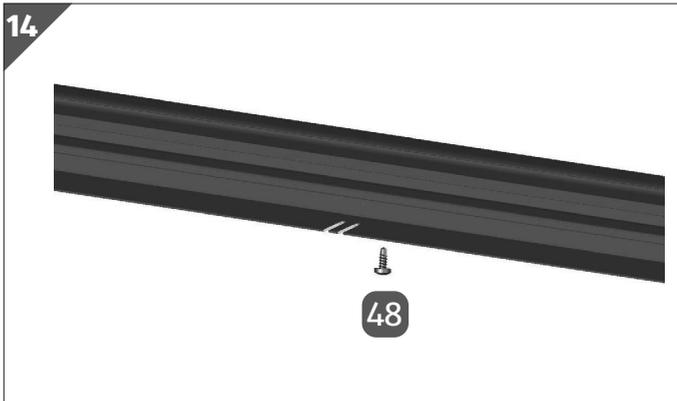
5. Fixieren Sie den First mit einer Bohrschraube 4,8×13 mm **48**.
