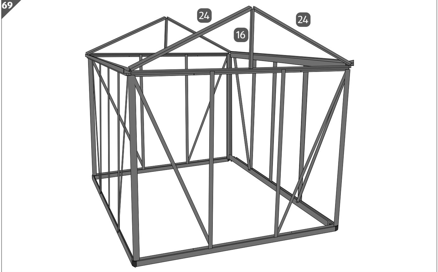
Im folgenden Bauabschnitt werden die Giebeleckprofile angebracht.
