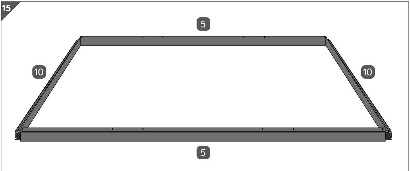
Im folgenden Bauabschnitt werden die Bodenprofile **5** und **10** an den Ecken verbunden.
