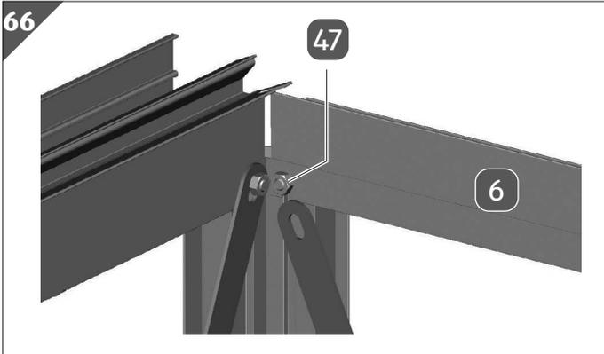
8. Lösen Sie die Mutter **47** an der Querstrebe **6**.
