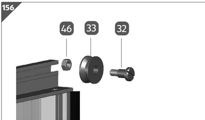
14. Befestigen Sie die Türrolle **33** mithilfe einer Mutter **46** und eines Achsbolzens **32**.
