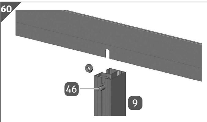
1. Stecken Sie eine Schraube M6/12 **46** in das Türeingang/Türseitenprofil **9**.
