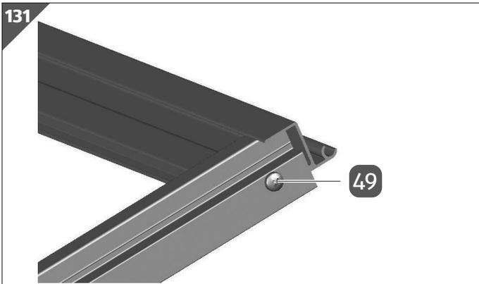
5. Befestigen Sie das Fensterprofil mit einer Blechschraube 4,2×22 mm **49** am Scharnierprofil.
