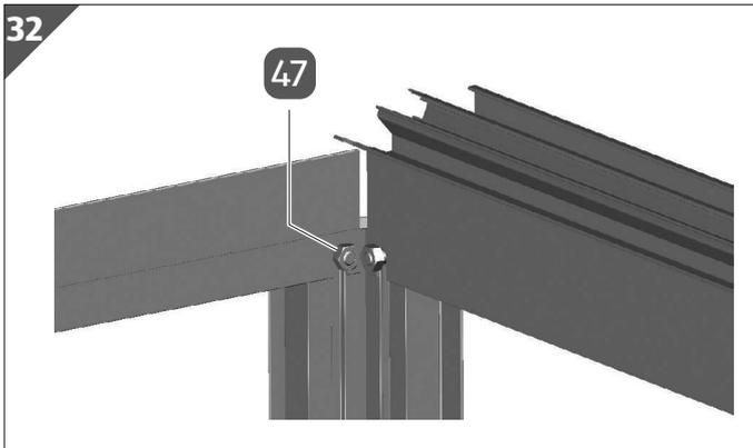
3. Fixieren Sie die Schraube M6/12 mit einer Mutter **47**.
