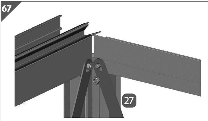
9. Platzieren Sie einen Windverband **27** auf der Schraube M6/12.
