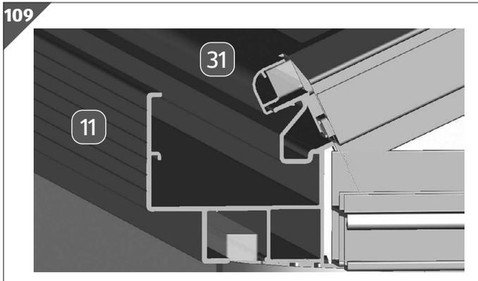
2. Stecken Sie die Halteclips Dacheck/Regenrinne **31** auf die Dachplatten **3** bzw. Fensterplatten **4** und die Regenrinne **11**.
