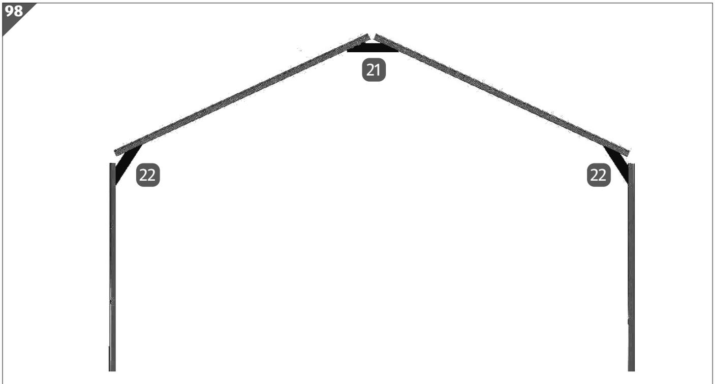
Im folgenden Bauabschnitt werden das Knotenblech First **21** und die Knotenbleche Regenrinne **22** angebracht.
