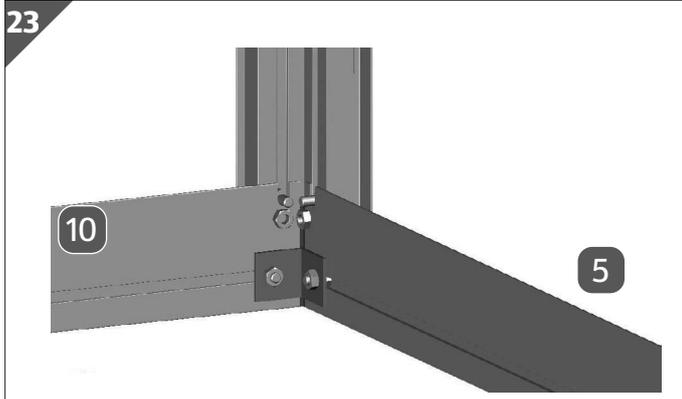
2. Stecken Sie das Seiteneckprofil auf die beiden Bodenprofile **5** und **10**.
