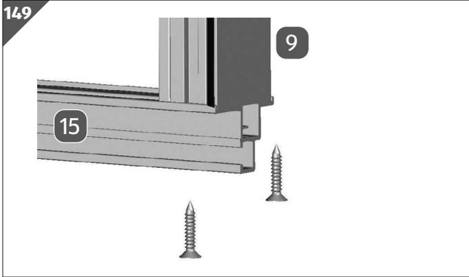
8. Legen Sie das zweite Türrollenprofil **15** an das Türeingang/Türseitenprofil **9**.
