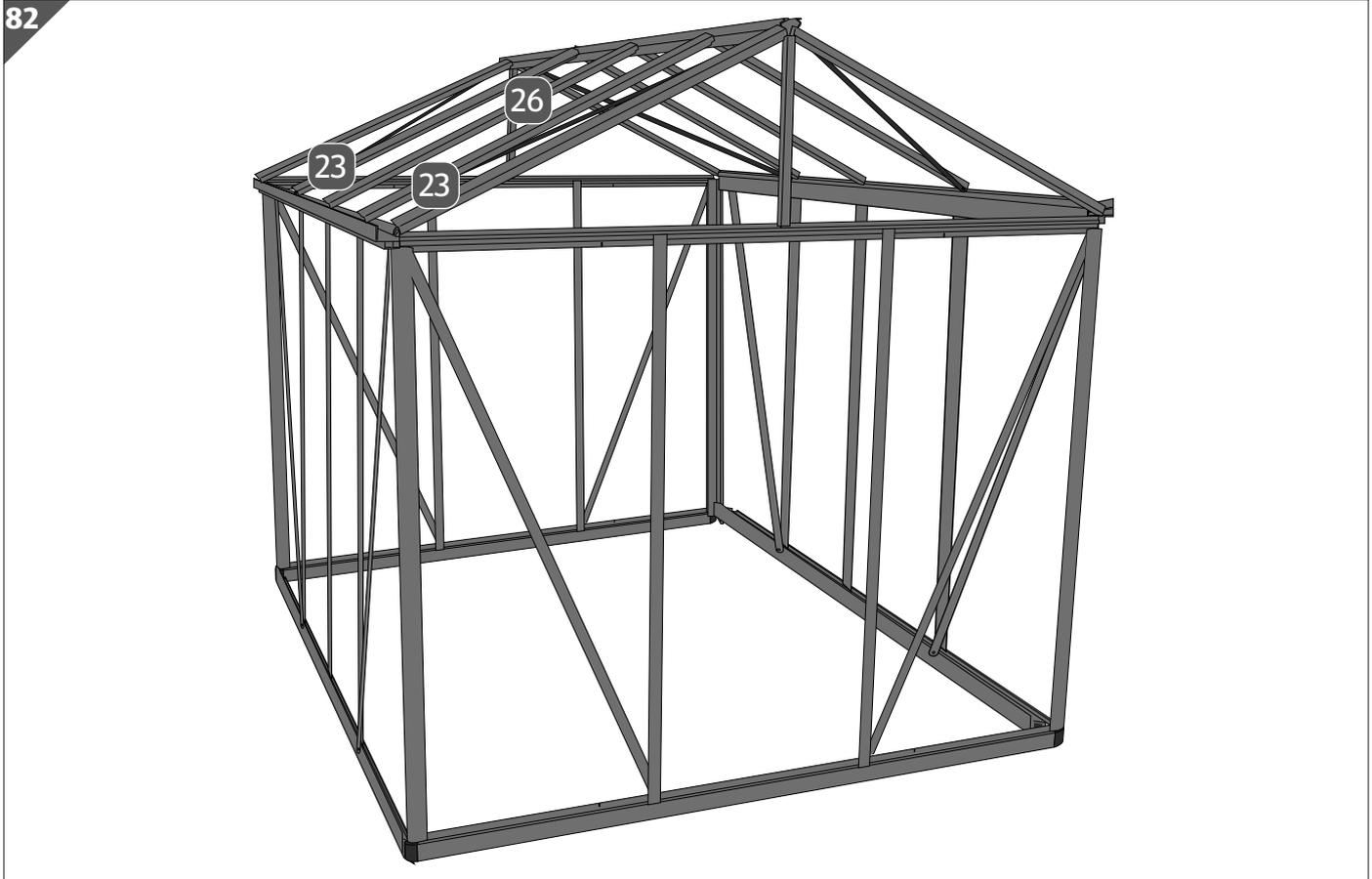
Im folgenden Bauabschnitt werden die Dachstreben **23** und die Koppelstreben **26** angebracht.
