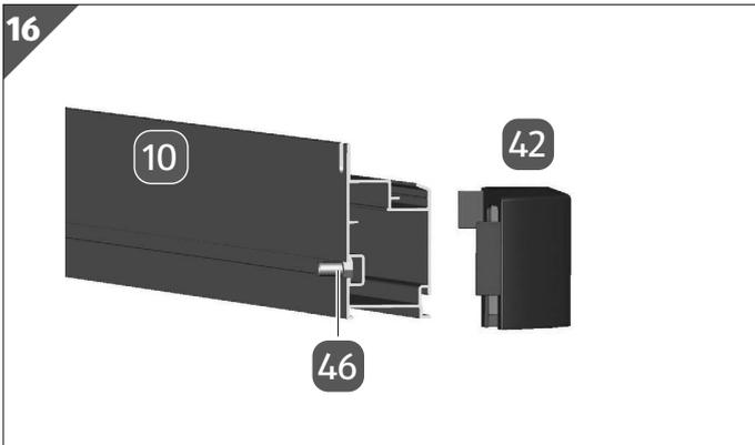
1. Stecken Sie eine Schraube M6/12 (46) in das Bodenprofil (10).
