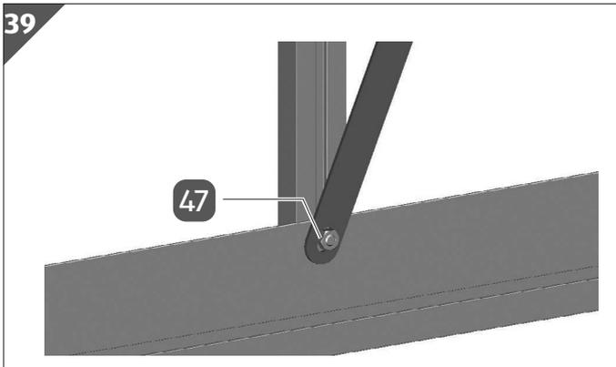
7. Fixieren Sie die Schraube M6/12 mit einer Mutter **47**.
