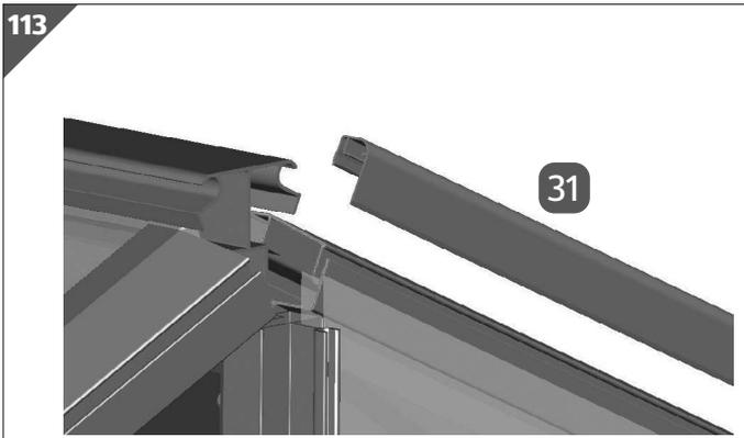
2. Stecken Sie die Halteclips Dacheck/Regenrinne **31** auf die Dreiecksplatte.
