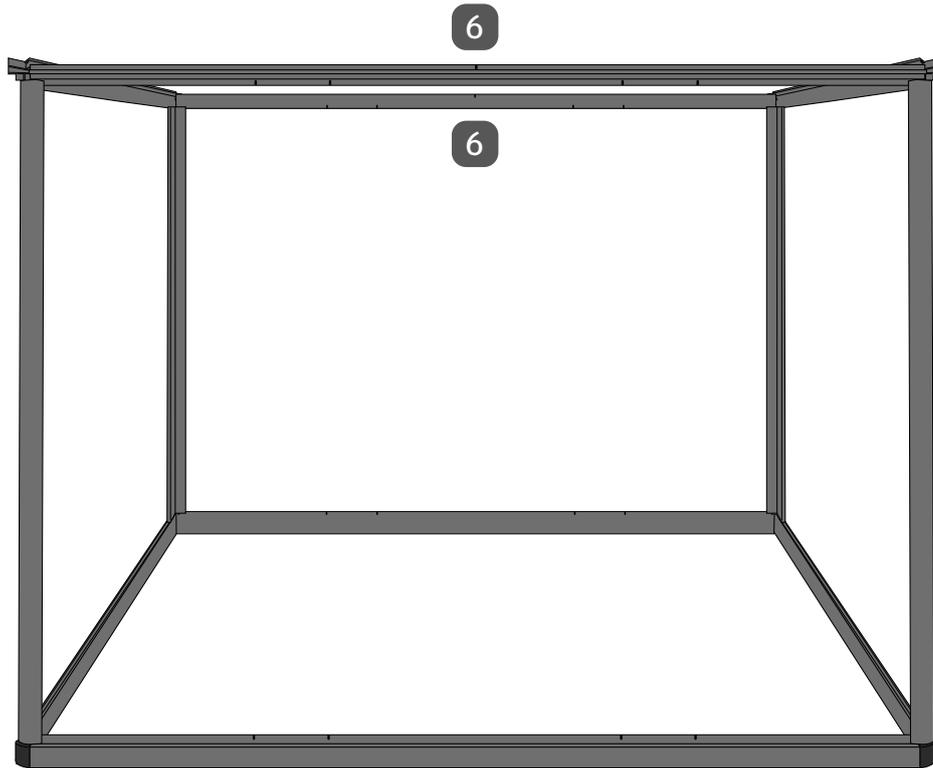
Im folgenden Bauabschnitt werden die Querstreben **6** angebracht.
