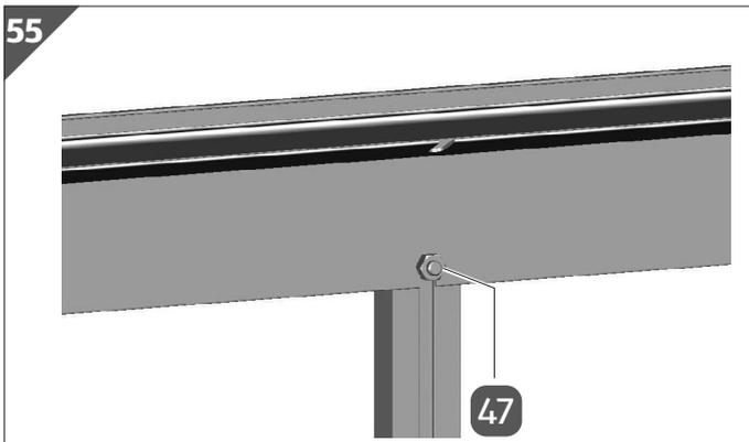
14. Fixieren Sie die Schraube M6/12 mit einer Mutter **47**.
