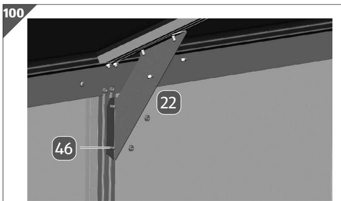
2. Platzieren Sie die Verstärkung **22** auf den Schraube M6/12 **46**.
