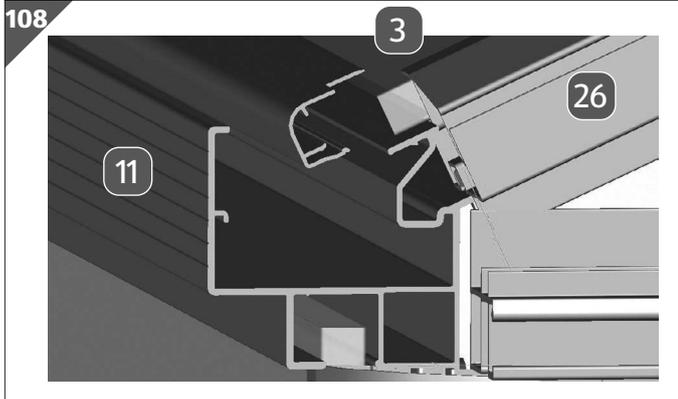
1. Platzieren Sie die Dachplatten **3** und zwei der vier Fensterplatten **4** auf den Koppelsebenen **26**, Dachstreben **23**, der Regenrinne **11** und dem First **12**.
