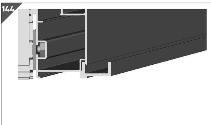
3. Die untere Türschiene steckt nun fest im Bodenprofil.
