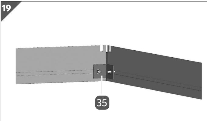
5. Platzieren Sie einen Winkel für das Bodenprofil (35) auf beiden Schrauben M6/12.
