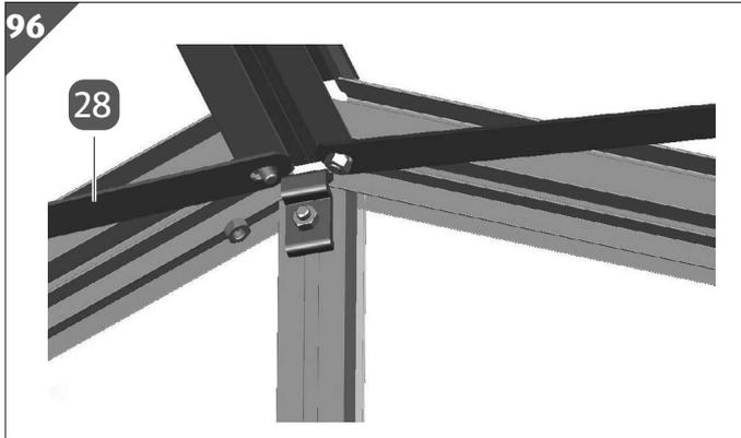
17. Platzieren Sie einen Windverband **28** auf der Schraube M6/12.
