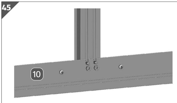
2. Stecken Sie die Koppelstrebe für die Wand **25** in das Bodenprofil **10**.
