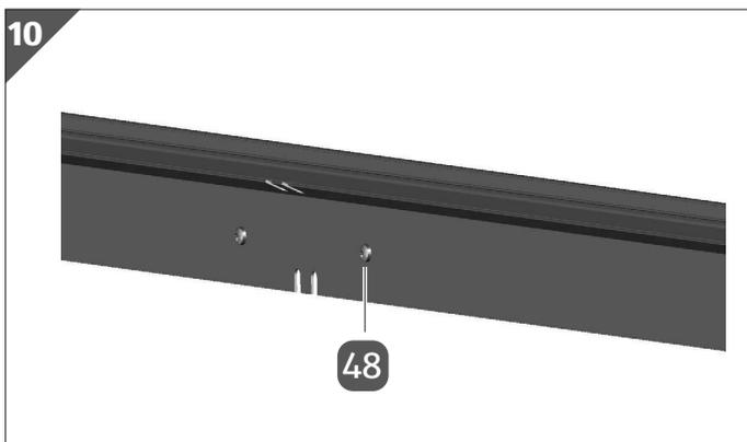
5. Fixieren Sie die Regenrinne mit einer Bohrschraube 4,8×13 mm **48**.
