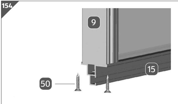
13. Befestigen Sie das Türrollenprofil **9** mit zwei Blechschrauben Senkkopf 4,2×22 mm **50** am Türeingang/Türseitenprofil **15**.
