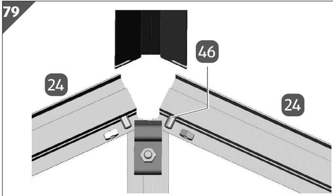
1. Stecken Sie zwei Schraube M6/12 **46** in die Giebeleckprofile **24**.
