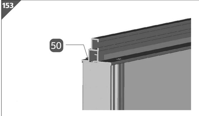
12. Befestigen Sie das Türrollenprofil mit zwei Blechschrauben Senkkopf 4,2×22 mm **50** am Türeingang/Türseitenprofil.
