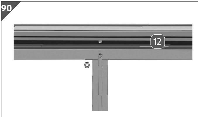
10. Stecken Sie die Dachstrebe in den First **12**.
