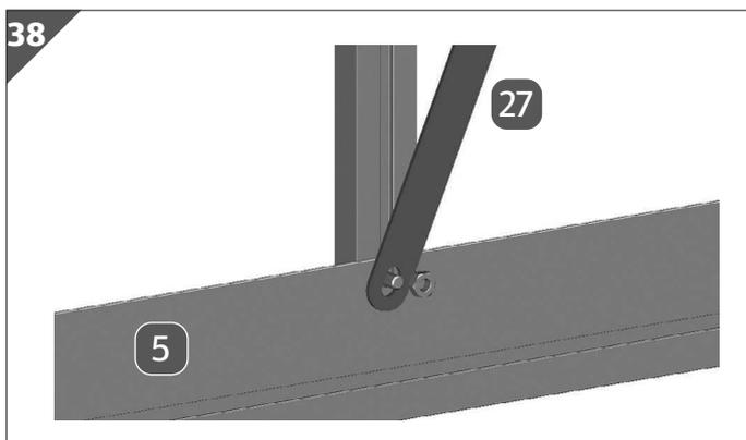
5. Stecken Sie die Wandstrebe auf das Bodenprofil **5**.
