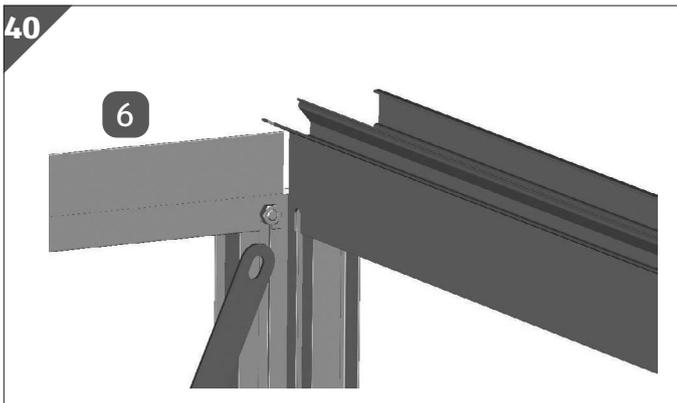
8. Lösen Sie die Mutter an der Querstrebe **6**.
