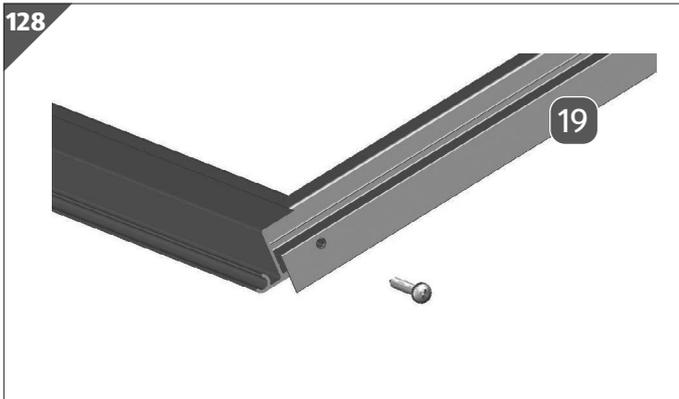
2. Legen Sie das seitliche Fensterprofil **19** an das Scharnierprofil.
