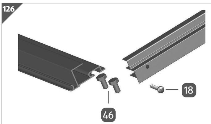
Die in der Abbildung gezeigten Schrauben M6/12 **46** werden nur auf einer Seite in den Schraubenkanal des Scharnierprofils **18** eingeführt.
