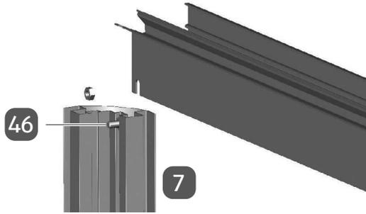
1. Stecken Sie eine Schraube M6/12 (46) in das Seiteneckprofil (7).
