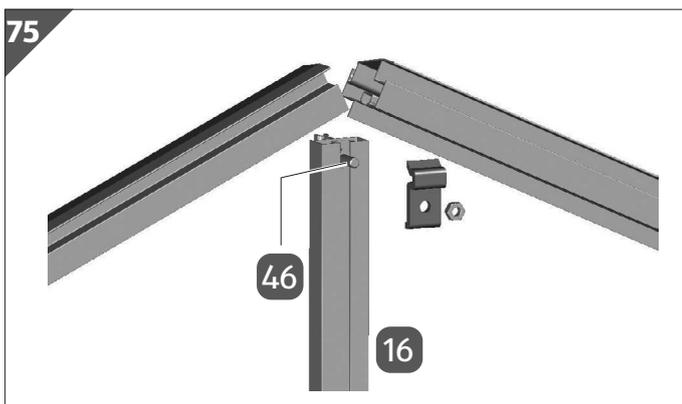
7. Stecken Sie eine Schraube M6/12 **46** in die Dachstütze **16**.
