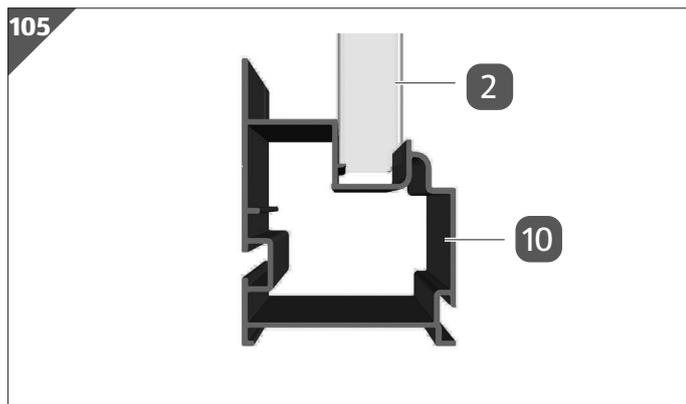
1. Stecken Sie die Stegplatten **2** in die Bodenprofile **10**.
