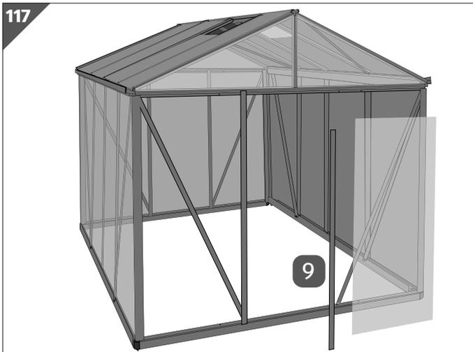
1. Entfernen Sie das Türeingang/Türseitenprofil **9**, indem Sie die Muttern lösen.
