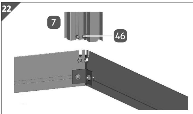
1. Stecken Sie zwei Schrauben M6/12 **46** in das Seiteneckprofil **7**.
