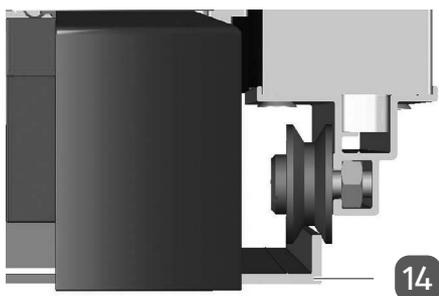
19. Setzen Sie die untere Türrolle in die untere Türschiene **14** ein.
