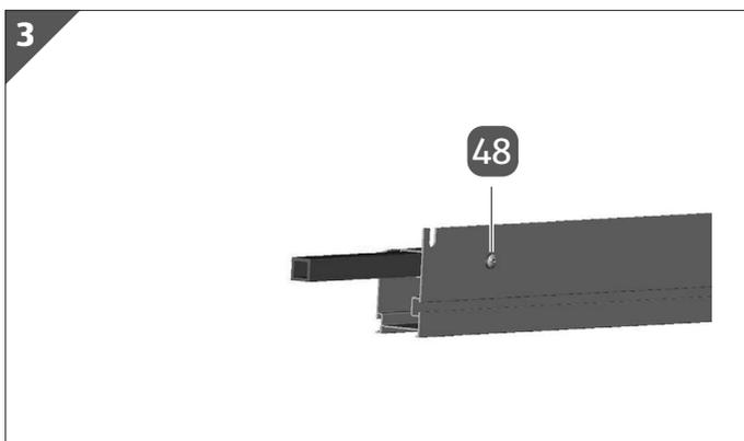
3. Fixieren Sie den Verbinder mit einer Bohrschraube 4,8×13 mm **48**.
