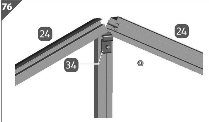
8. Stecken Sie die Befestigungsklemme **34** auf die Schraube M6/12.
