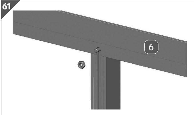
2. Stecken Sie das Türeingang/Türseitenprofil in die Querstrebe **6**.
