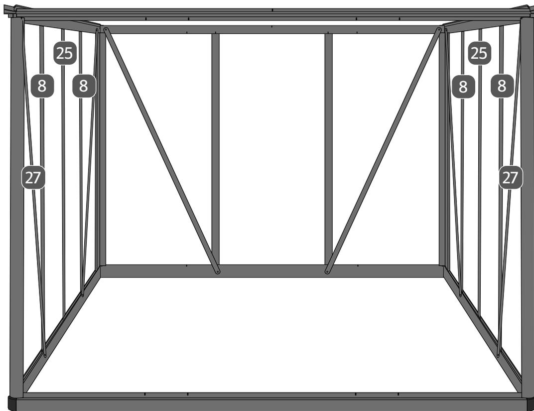
Im folgenden Bauabschnitt werden die Koppelstreben **25**, Wandstreben **8** und Windverbände **27** der Seitenwände angebracht.
