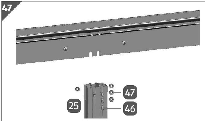
4. Stecken Sie vier Schrauben M6/12 **46** in die Koppelstrebe für die Wand **25**.
