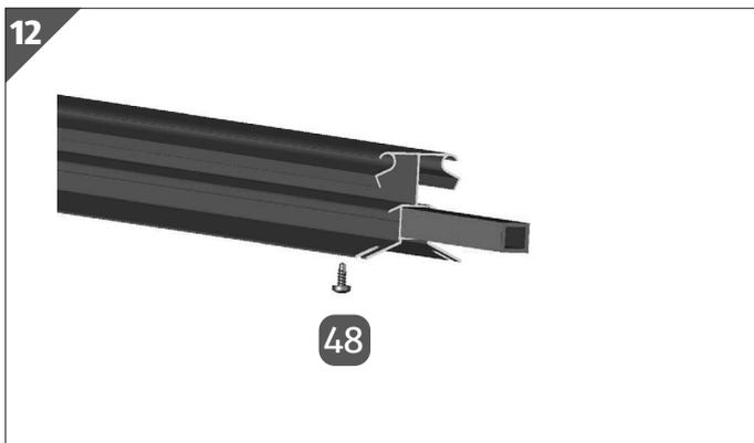
2. Stellen Sie sicher, dass der Verbinder 125 mm aus dem First herausragt.
