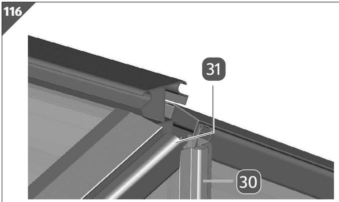
4. Stecken Sie die Halteclips Dacheck/Regenrinne **31** auf die Dreiecksplatte.
