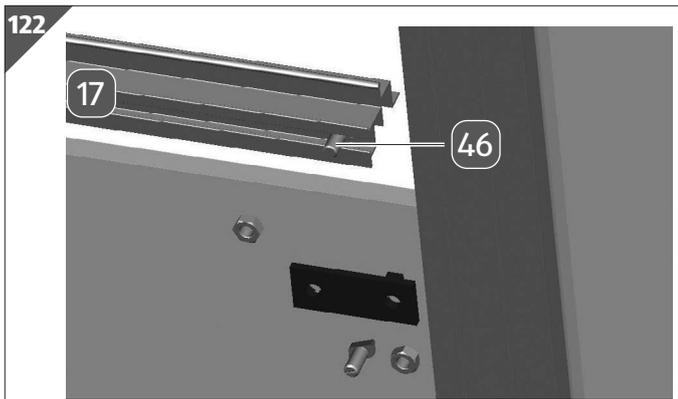
1. Stecken Sie eine Schraube M6/12 **46** in das Fensteranschlagprofil **17**.
