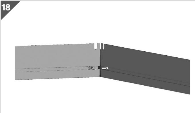
4. Stecken Sie das zweite Bodenprofil auf die Abdeckkappe für das Bodenprofil.
