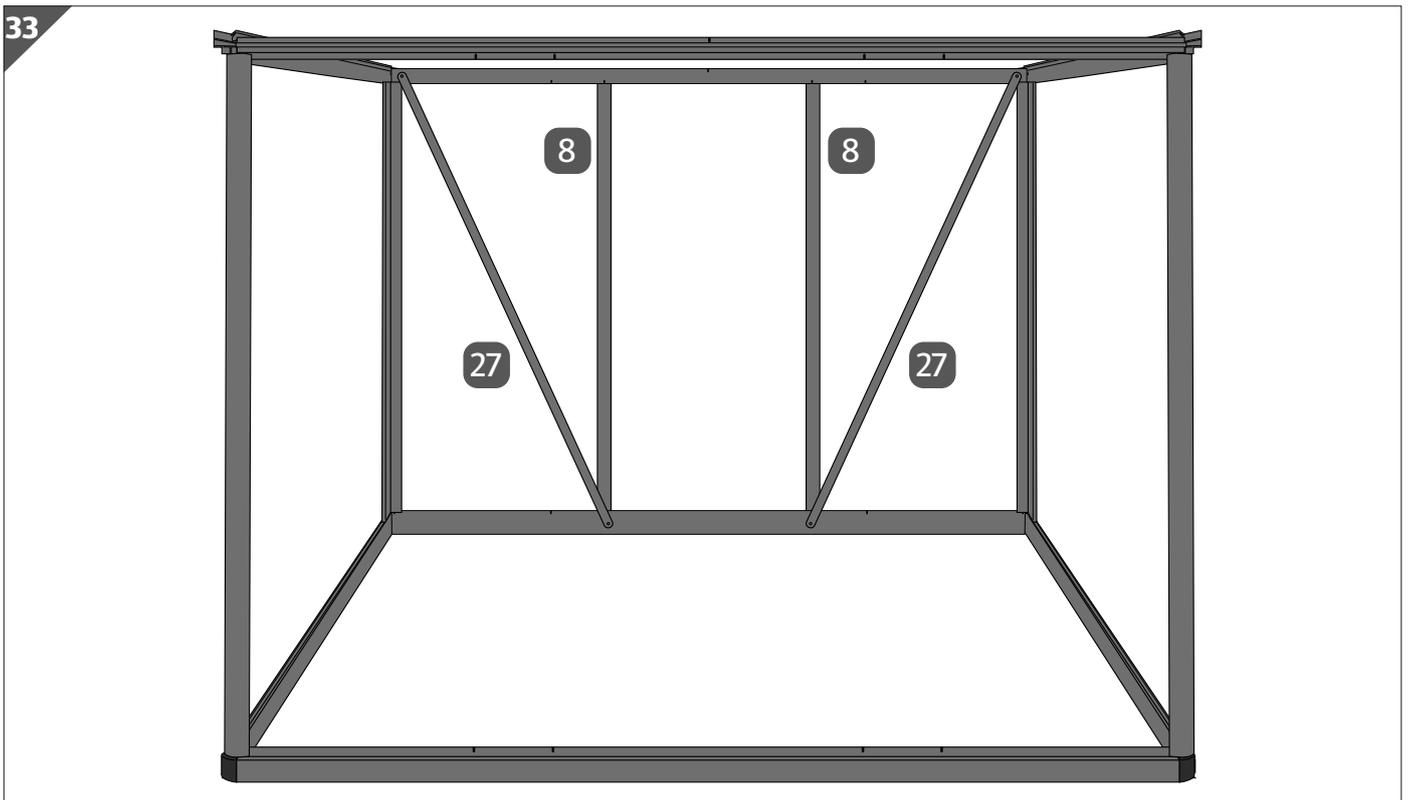
Im folgenden Bauabschnitt werden die Wandstreben **8** und die Windverbände **27** der Rückwand angebracht.
